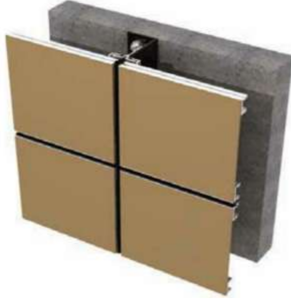
Şekil 2.56 İnce porselen seramik levha Çuhadarođlu SX sistem montaj detayı (www.kale.com.tr, 2012)
