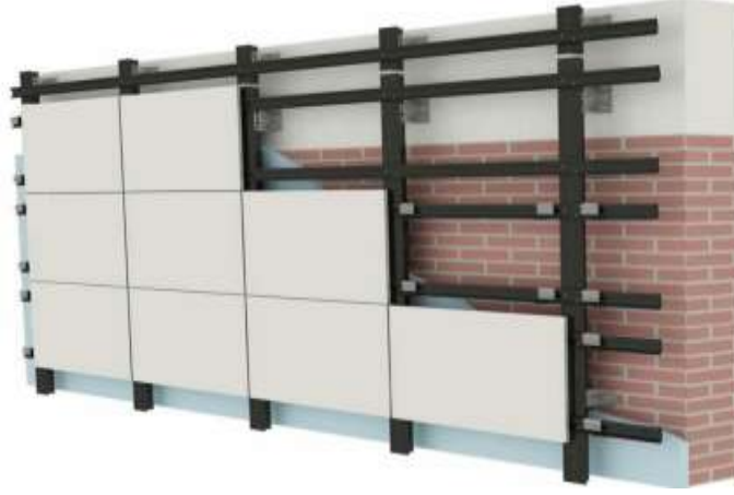
Şekil 2.54 Granit Seramik Gizli sistem montaj detayı ( www.kale.com.tr,2012)
