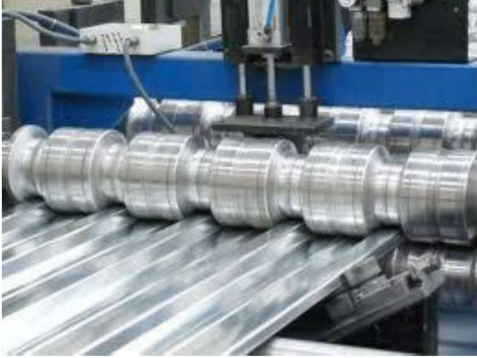
Şekil 2.13 Galvanize trapez sac oluşumu (www.erdemir.com, 2012)
