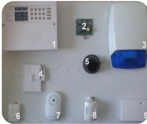
Resim 17 - Güvenlik sisteminin genel bir görünüşü (1-Alarm paneli, 2-Telefon arayıcı, 3-Siren, 4-Manyetik kontak, 5-Kamera, 6-Cam kırılma detektörü, 7-Gaz detektörü, 8-Hareket detektörü, 9- Keypad).
