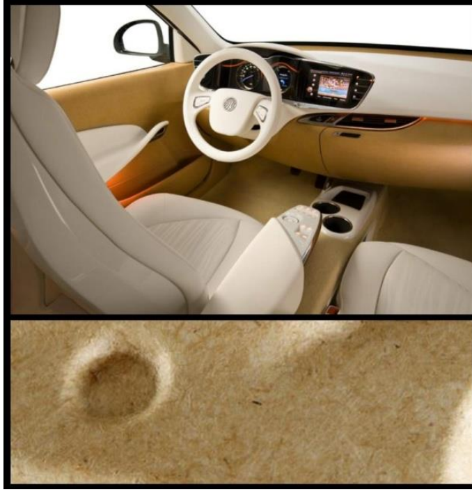
Resim 1.55. Johnson Controls firmasının geliřtirdiđi grnebilir liflerden oluřan dođal malzemeden elde edilen materyal ve uygulama alanları.
