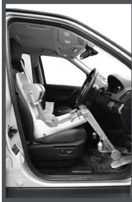
Resim 1.15. "Otomotiv Mühendisleri Kurumu"nun (SAE) çeşitli testlerde kullandıkları "H-Point" Makinası.
