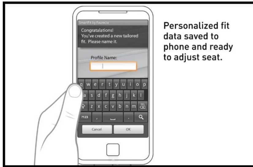
Resim 1.38. Faurecia firmasının bluetooth teknolojisi ile ayarların kişiselleştirilmesi.
