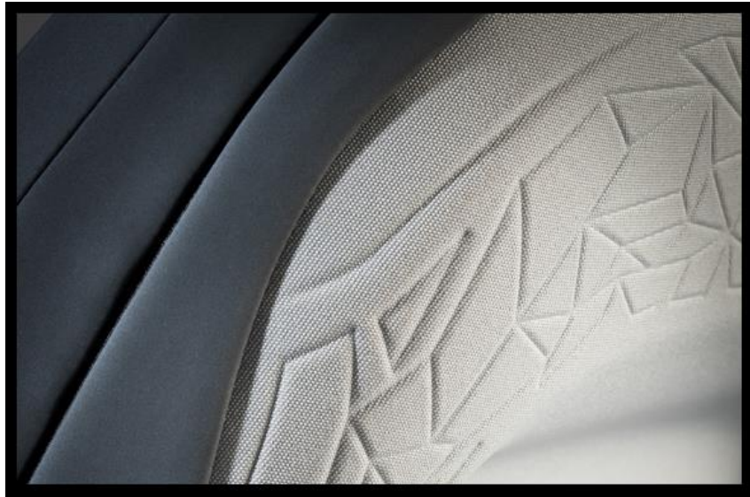
Resim 1.36. Faurecia firmasının kaplama oyma teknolojisi ile üretilen kaplama örneği.
