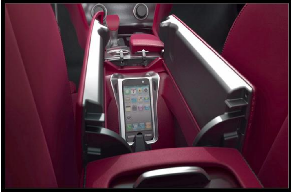
Resim 1.81. Faurecia firmasının "HMI: WiCharge" şarj sistemi konsol tasarımı.
