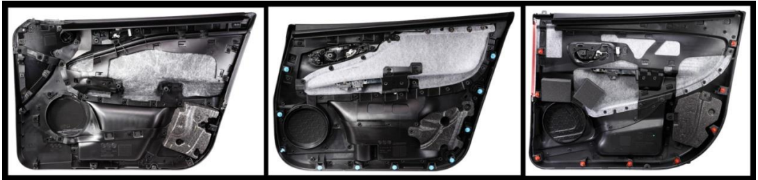
Resim 1.59. Firmasının geliştirdiği Wood-Stock isimli materyalin Alfa Giulietta, Fiat Evo ve Lancia Ypsilon modelleri üzerinde uygulanması.
