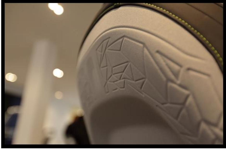
Resim 1.34. Faurecia firmasının kaplama oyma teknolojisi ile üretilen kaplama örneği.
