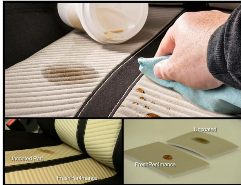
Resim 1.26. Johnson Controls firmasının "Freshper4mance" koltuk kaplama teknolojisi.
