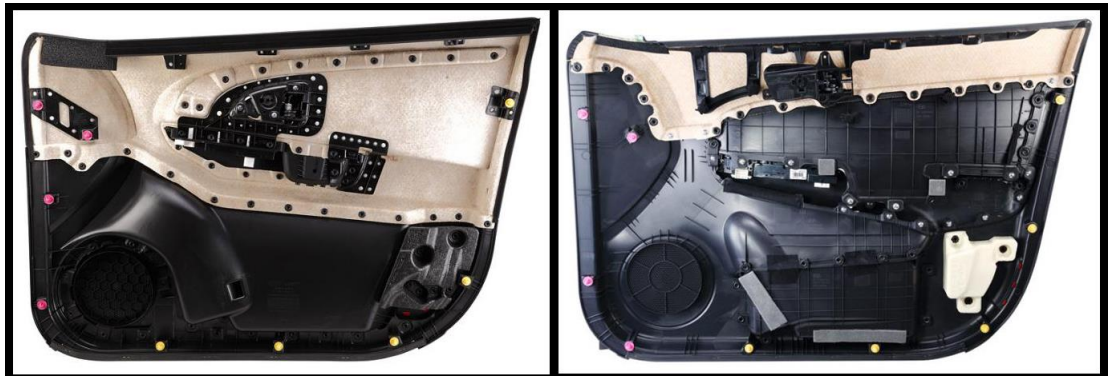
Resim 1.37. Johnson Controls firmasının geliştirdiği Fibrowood isimli materyalin uygulama alanları.
