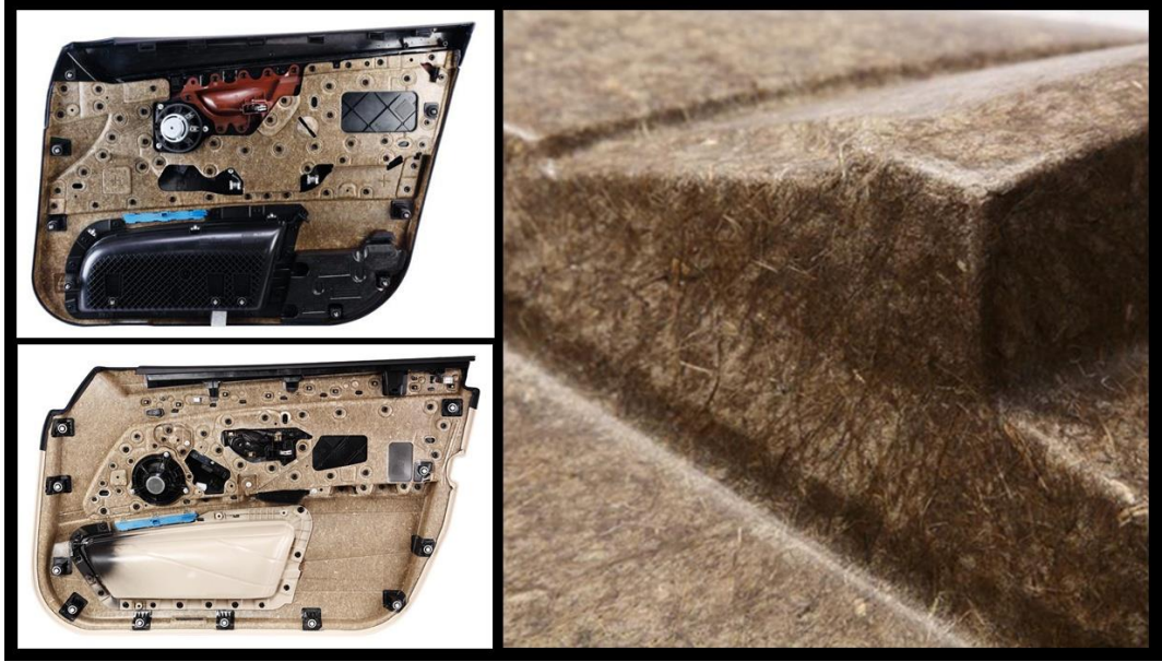
Resim 1.58. Johnson Controls firmasının geliştirdiği NF-EP isimli materyal ve uygulama alanları.
