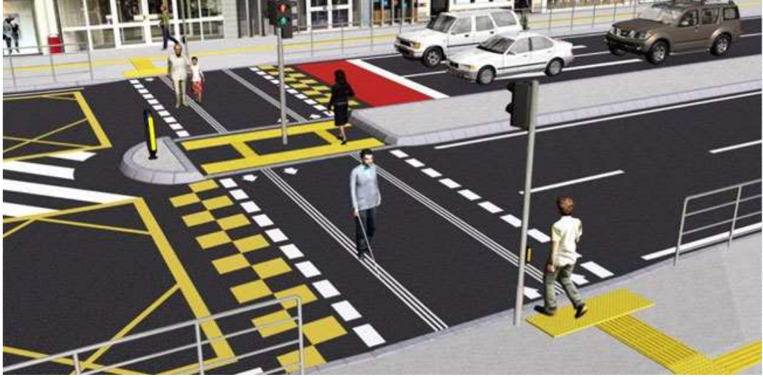
Şekil 2.5. İstanbul Büyükşehir Belediyesi'nin uygulamış olduğu görme engelli bireylerin buldukları yolda rahat hareket edebilmeleri için kullandıkları kabartmalı hissedilebilir yüzey (klavuz taşı) uygulaması simülasyonu çalışması
