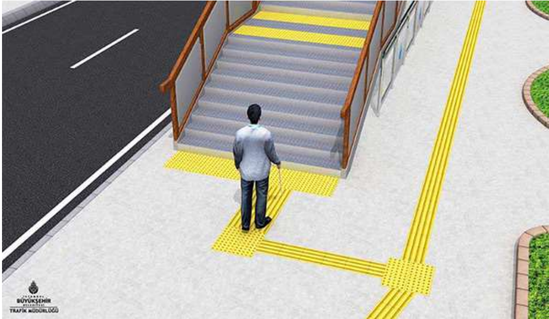
Şekil 2.6. İstanbul Büyükşehir Belediyesi'nin uygulamış olduğu görme engelli bireylerin buldukları yolda rahat hareket edebilmeleri için kullandıkları kabartmalı hissedilebilir yüzey (klavuz taşı) uygulaması simülasyon çalışması
