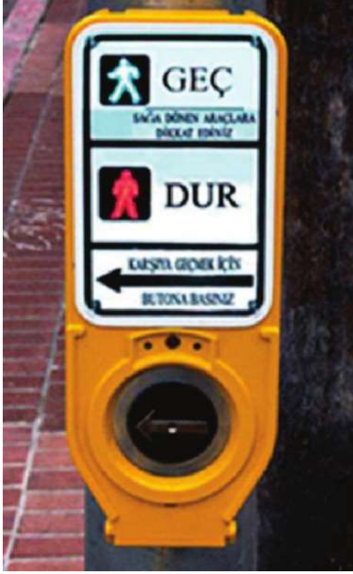
Şekil 3.26. Işık kontrollü yaya geçişlerinde kullanılan ışıklı, sesli ve hissedilebilir kabartma yüzeyli cihaz. Haziran 2012 tarihli TS 12576 nolu standart. s.26
