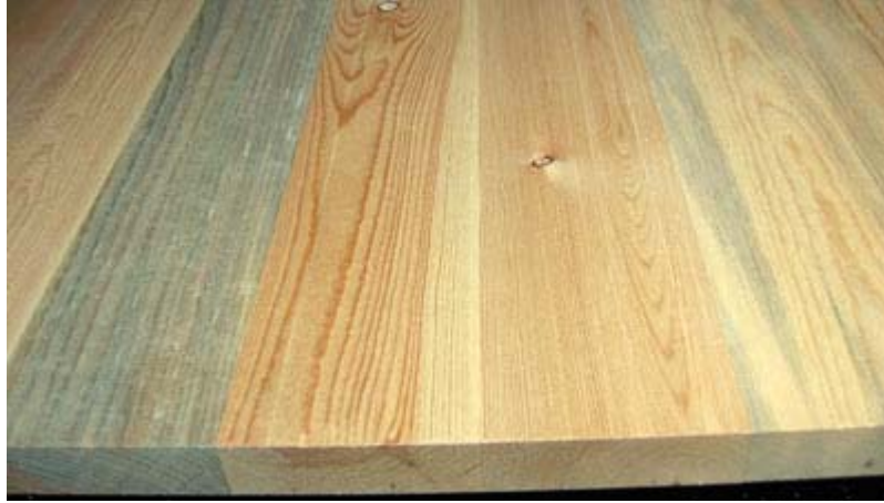
Resim 4.1: Kereste üzerinde mavileşme
