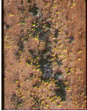
Resim 4.2: Ahşabın küflenmesine örnek
