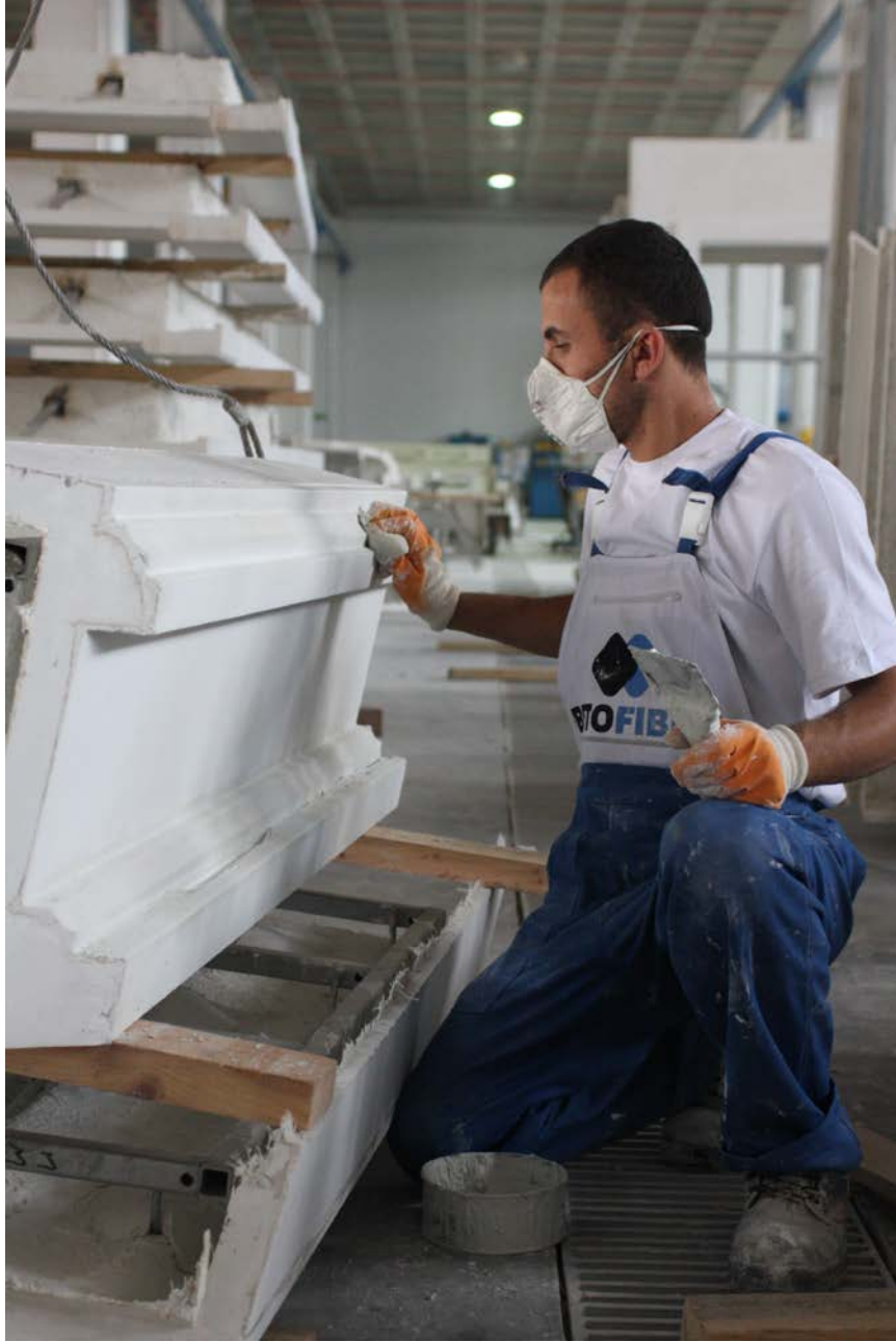
Şekil 3.20.: Döküm sonrası kalıptan çıkan GRC elmana bakım tamirâtı yapımı (özgün arşivinden, 2014)
