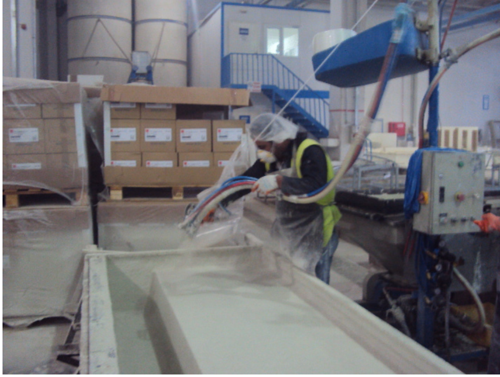
Şekil 3.16.: GRC sprey püskürtme tekniğiyle yapılan döküm aşaması (özgün arşivinden, 2013)
