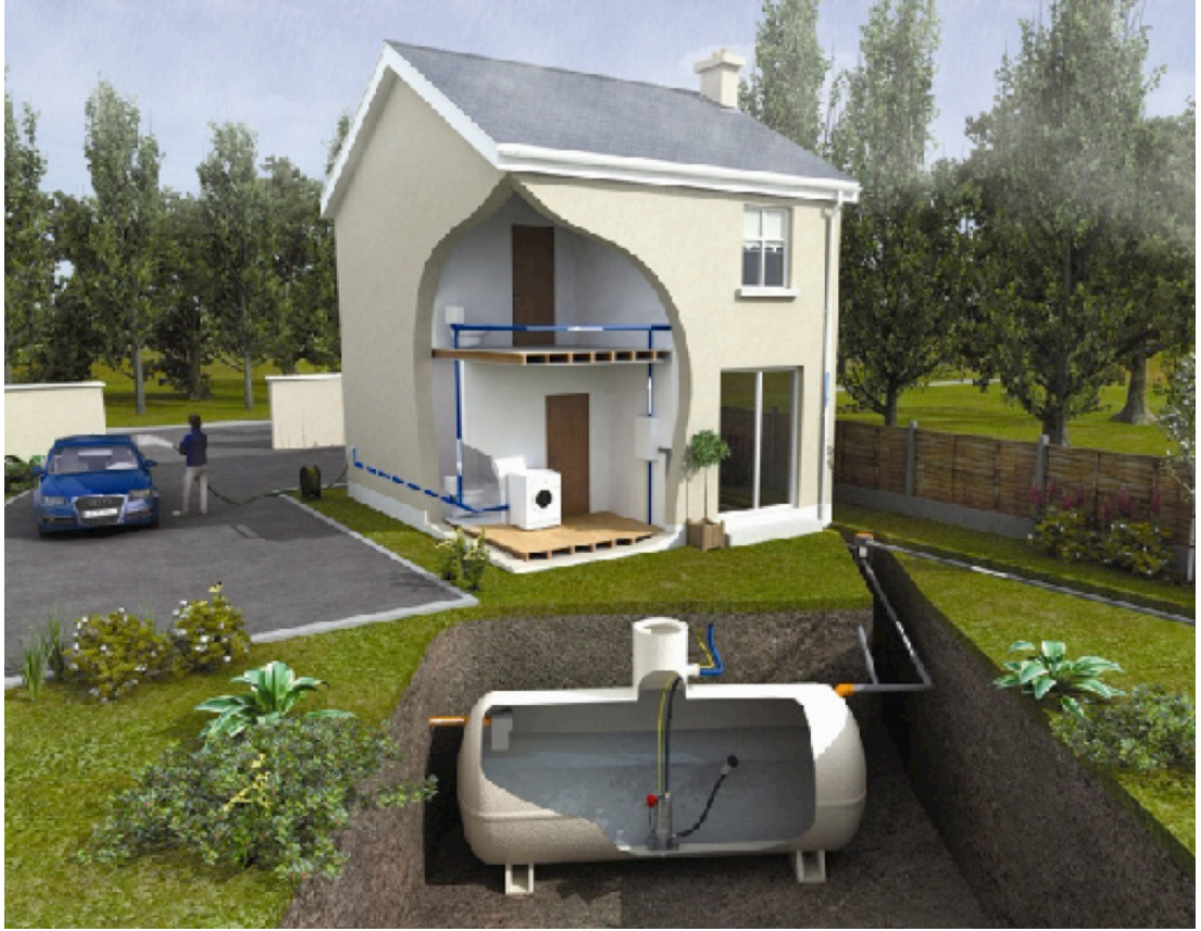
Şekil 5.3:Yağış sularının oluk sistemleri ile toplanarak depolanması
