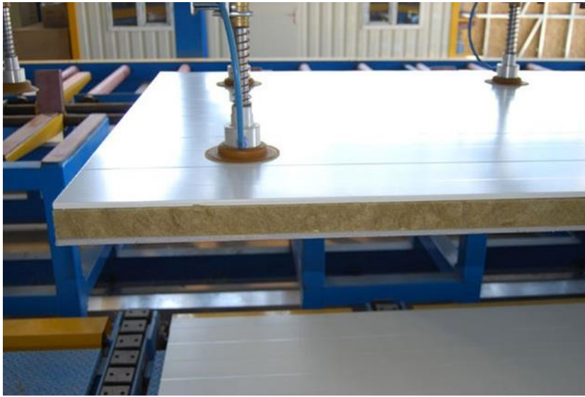
Resim 2.19. Neopan Teknolojisi İle Üretilen Panel
