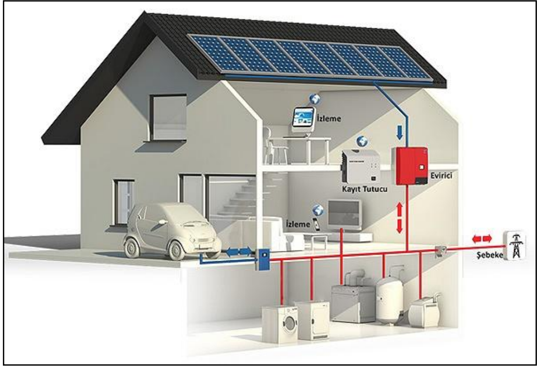
Şekil 3.16. Fotovoltaik Sistemin Şematik Gösterimi (URL-14)
