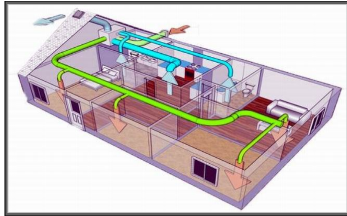
Resim 1.94. Konut içerisindeki havalandırma sisteminin görsel örneği (bimhavalandırma.com)
