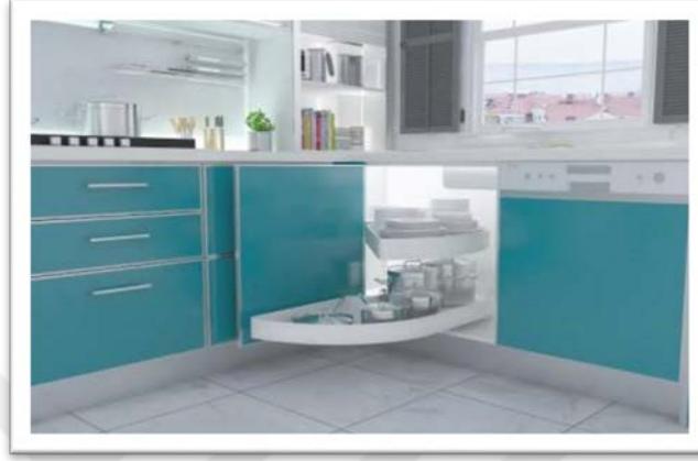
Resim 1.23. Köşe dolaplarında uygulanan döner mekanizmalı kapak (moda dekorasyon wep.)
