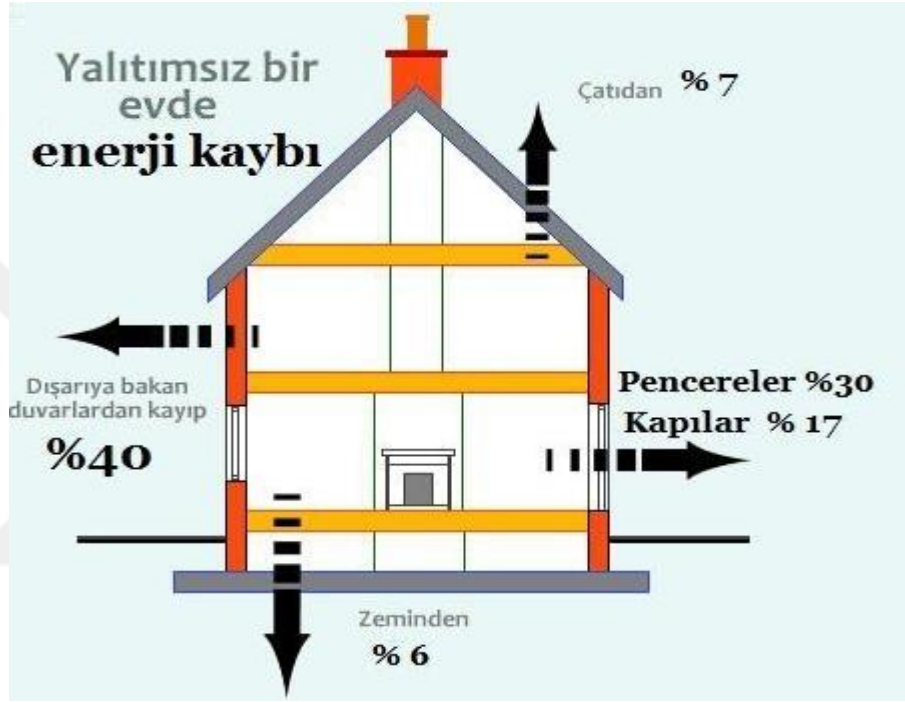
Şekil 5.1. Yapı Elemanlarında Isı Kaybı
