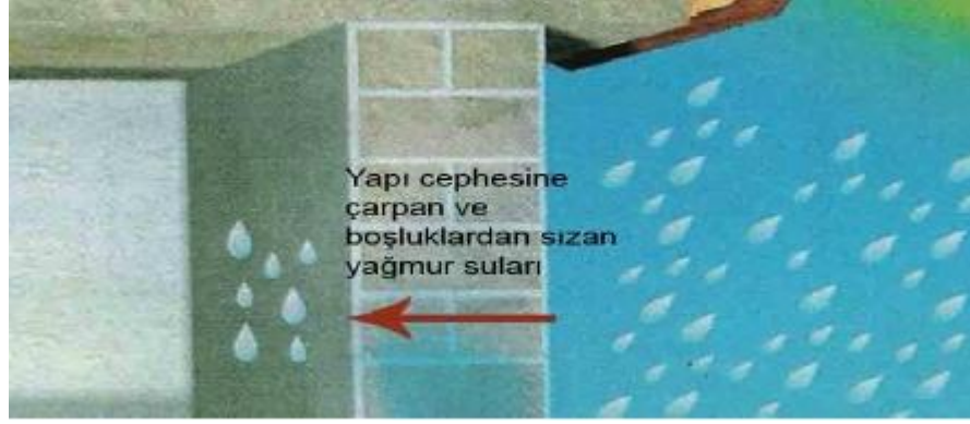
Şekil 2.21. Yağışların Yapı Cephesinde Etkisi
