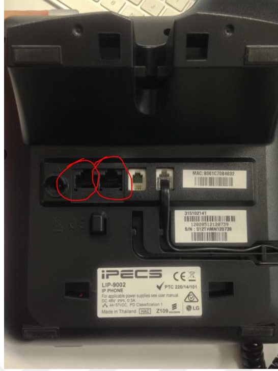
Şekil 5.17 LG Ericsson LIP 9002 Masa Telefonu Anahtarlama Özelliği
