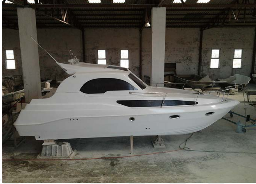
Şekil 4.10 Yapım aşamasındaki fibreglas malzeme kullanılarak üretilmekte olan bir yat (www.euroboat-turkey.com.,Erişim tarihi: 30.01.2019)
