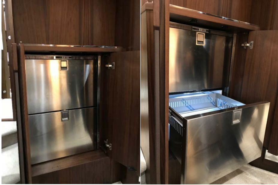
Şekil 6.22 Yat mutfaklarında kullanılan buz makinesi (Can Arno Candan'ın Arşivinden: Tuzla Boat Show 2019, İstanbul)
