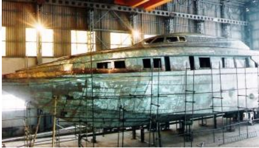
Şekil 4.8 Yapım aşamasındaki Alüminyum malzemeden üretilen bir yat (www.adayacht.com.,Erişim tarihi: 30.01.2019)
