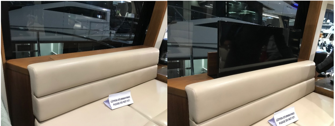
Şekil 7.16 Televizyonun mobilya içerisinde dışarıya doğru çıkması (Can Arno Candan'ın Arşivinden: Tuzla Boat Show 2019, İstanbul)
