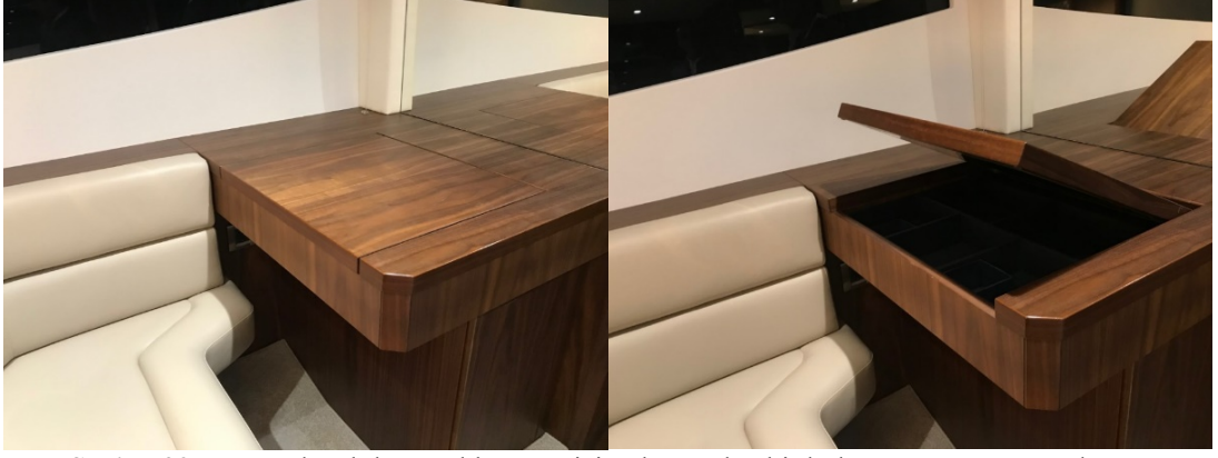
Şekil 7.29 Kamarada takıların saklanması için oluşturulan bir bölüm (Can Arno Candan'ın Arşivinden: Tuzla Boat Show 2019, İstanbul)
