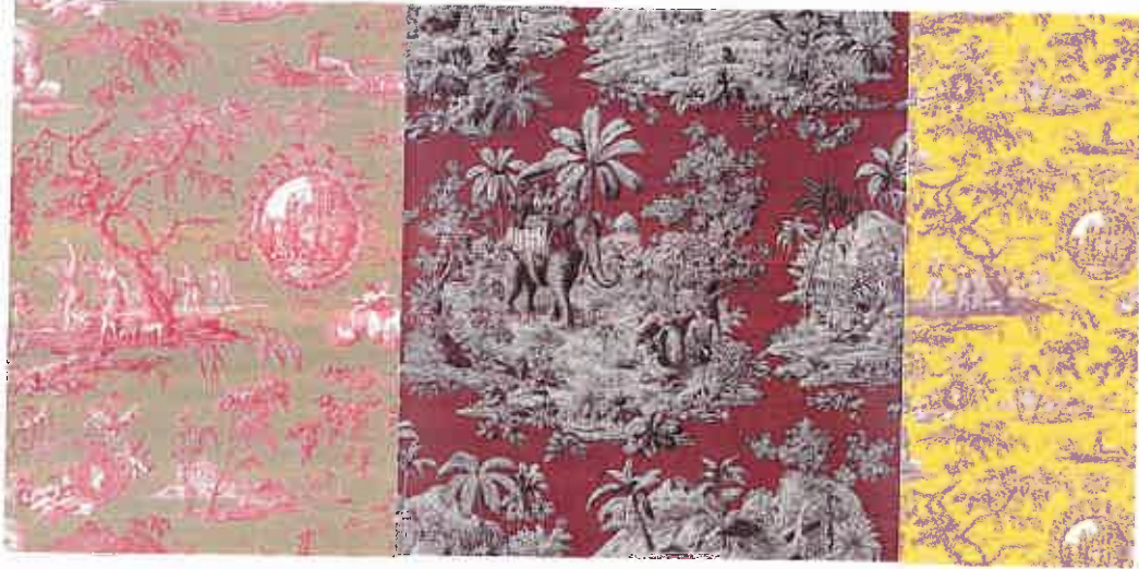
Şekil 3.4. C. P. Oberkampf’ın Jouy’daki Fabrikasında, Grave Edilmiş Bakır Plakalarla Yapılan Monokromatik Baskılı “Toile De Jouy” Kumaşları
