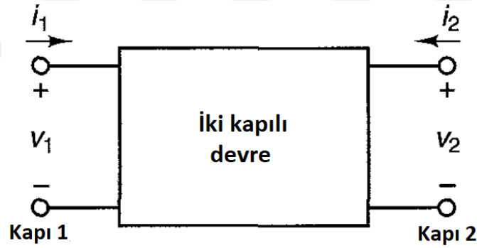
Şekil 4.27. İki kapılı devre akım ve gerilimleri
