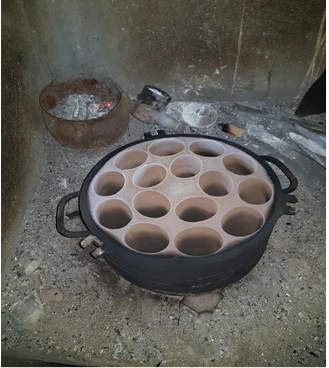
Şekil 3.70. Çan Üretiminde Kullanılan Erkek Kalıplar
