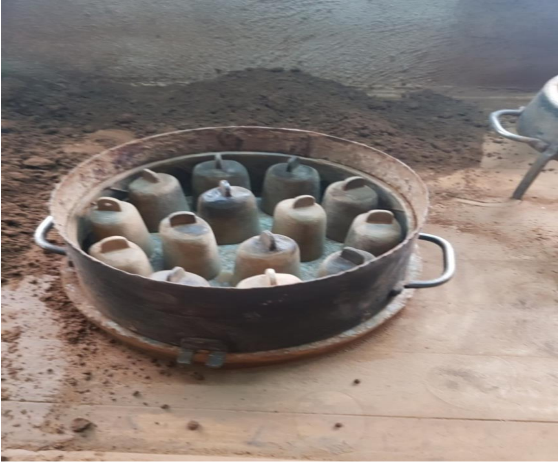
Şekil 3.71. Çan Üretiminde Kullanılan Dişi Kalıplar
