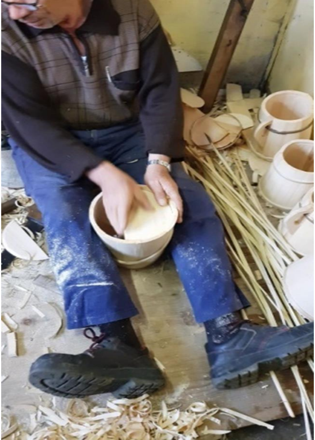
Şekil 3. 64. Ahşap Kabin Tabanlılık Kısımının Monte Edilmesi
