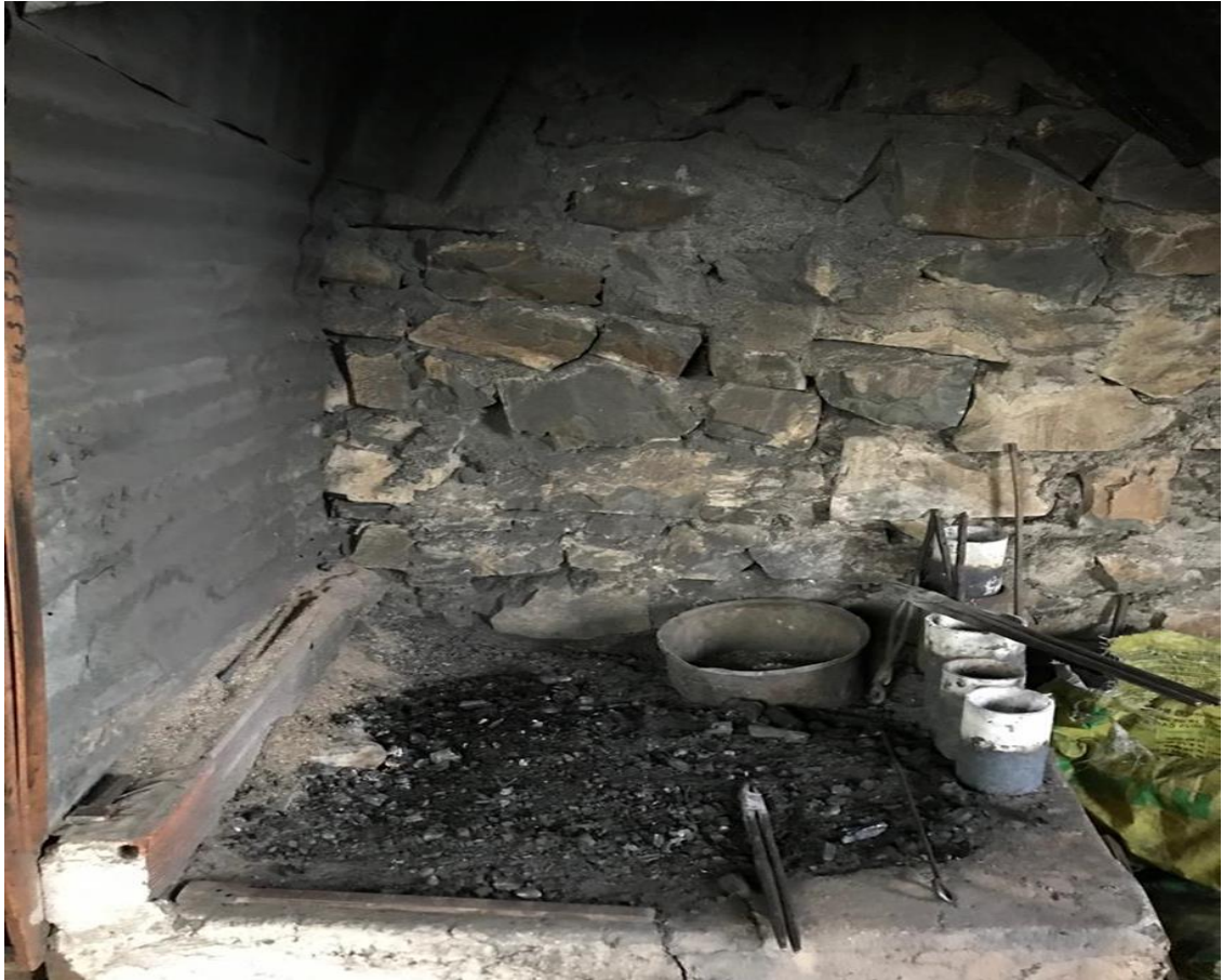
Şekil 3.74. Kantar İmalinde Pirincin Eritildiği Ocak
