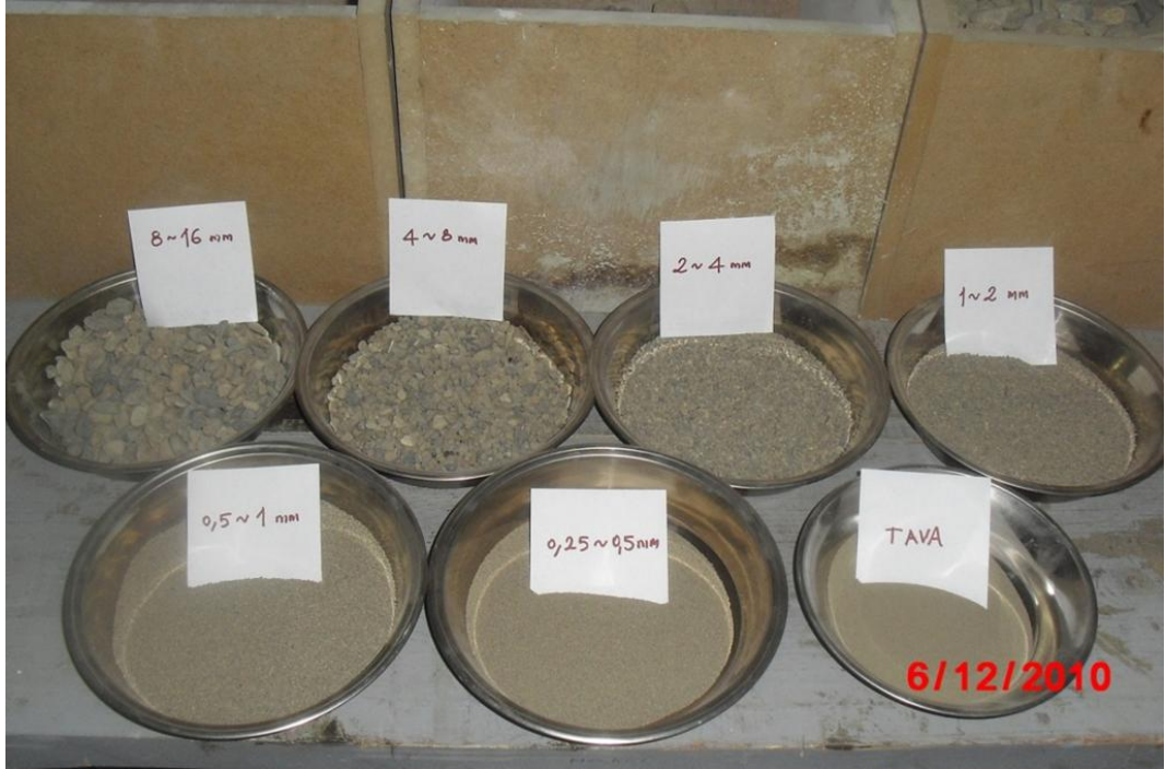
Şekil 4.12 Eleme sonucu elek üstü ve tavada kalan malzemeler
