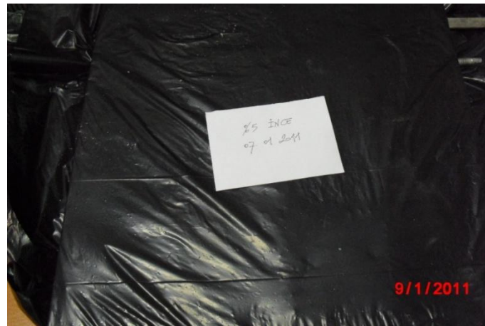
Şekil 4.35 Kaplanarak korumaya alınmış taze beton numuneleri
