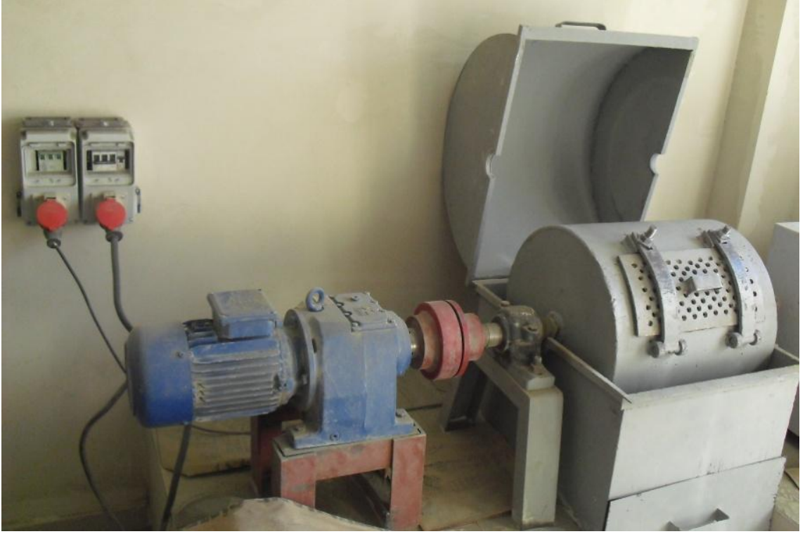
Şekil 4.15 Kalker malzemesinin inceltildiği öğütme değirmeni
