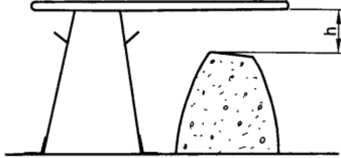
Şekil 4.40 Taze betonda çökme mesafesi, h
