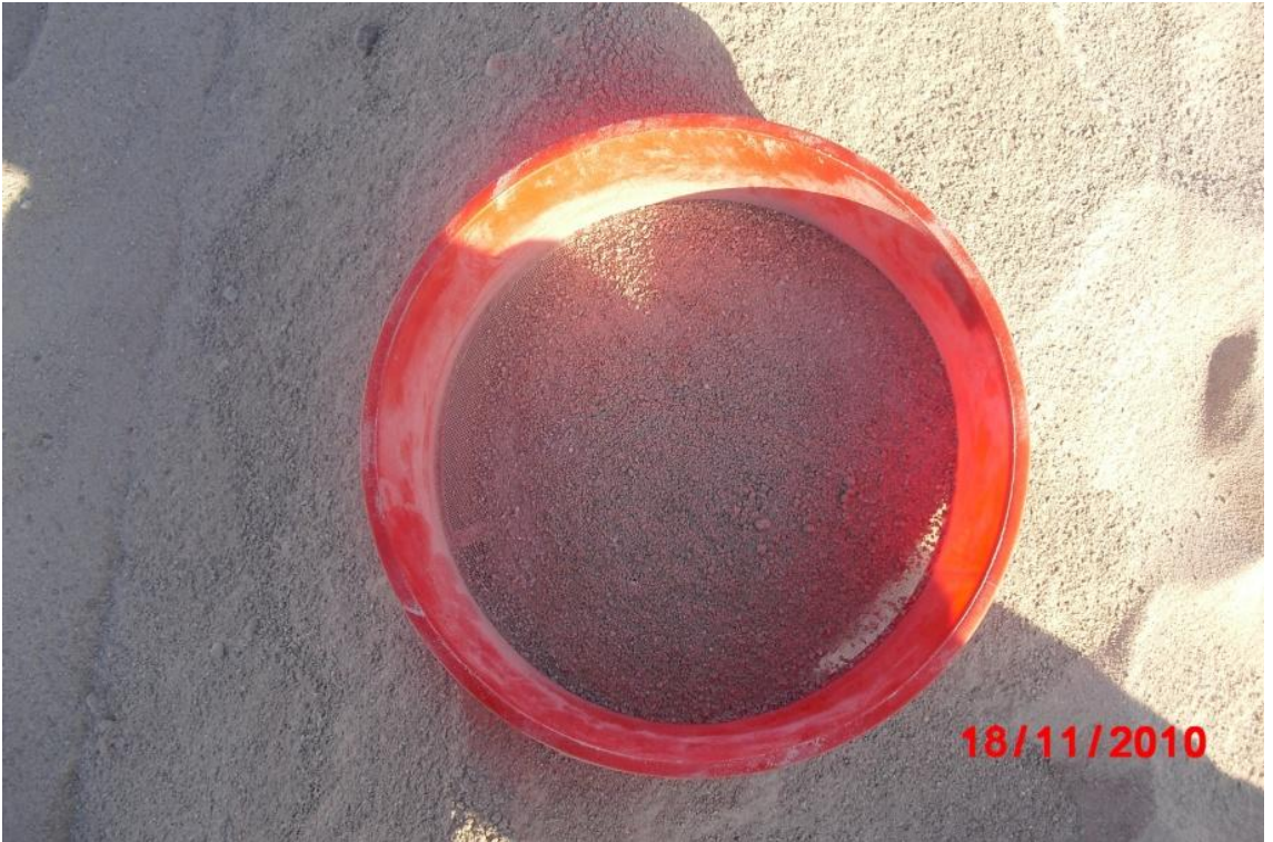
Şekil 4.14 Eleme ile kalker numunesi elde edilmesi
