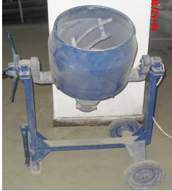
Şekil 4.33 Beton üretiminde kullanılan betoniyer
