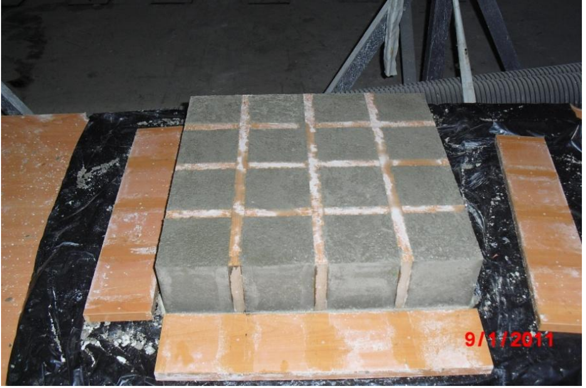
Şekil 4.36 Beton numunelerin kalıplardan çıkarılması
