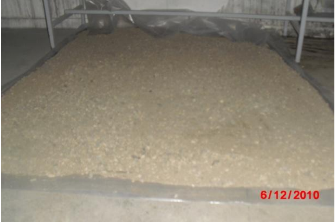
Şekil 4.7 Yıkanmış dere malzemesinin kurutulması
