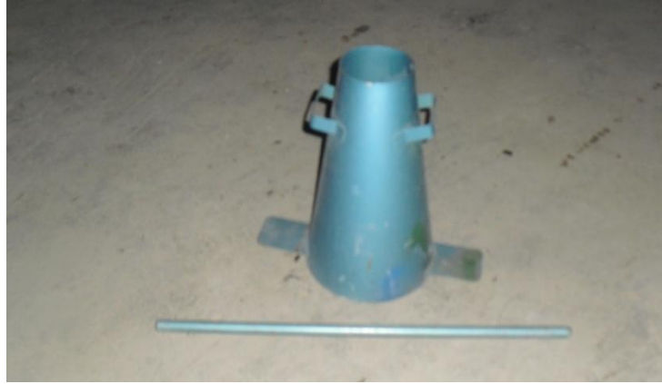
Şekil 4.38 Çökme deneyinde kullanılan kesik koni ve şişleme çubuğu
