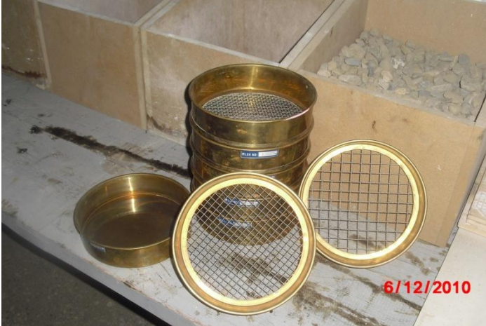
Şekil 4.10 Elek takımı (16-8-4-2-1-0.5-0.25 mm dizisi)
