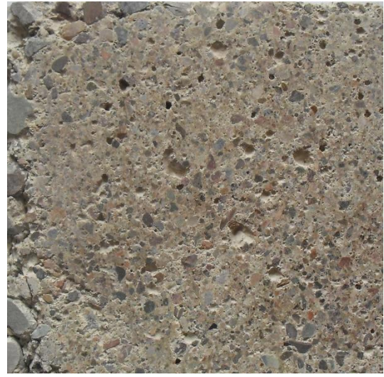
(b) %5 öğütme katkılı beton
