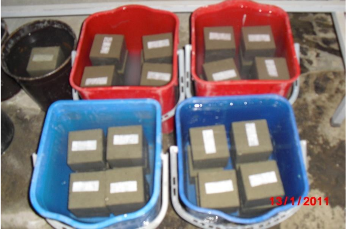
Şekil 4.37 Kür ortamında bekletilen beton numuneleri
