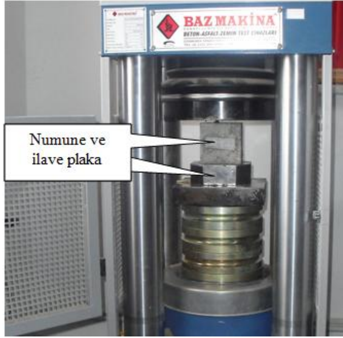
Şekil 4.48 Beton numunesine göre tabla aralığının ayarlanması
