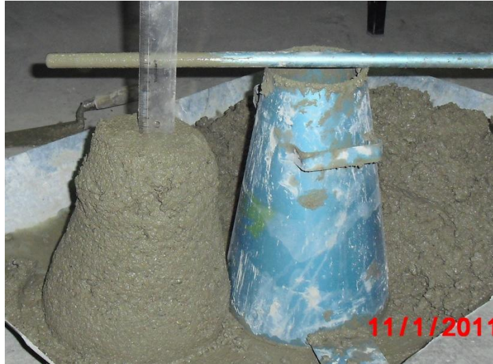
Şekil 4.41 Taze beton çökme değerinin ölçülmesi
