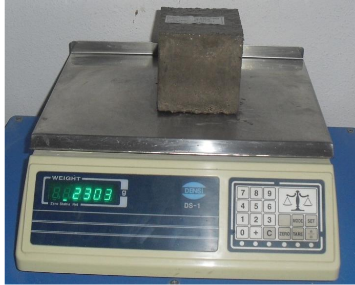
Şekil 4.47 Beton numunelerin tartılması
