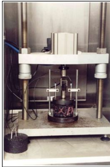
Şekil 2.17. Tekrarlı sünme deneyi test düzeneği[36].
