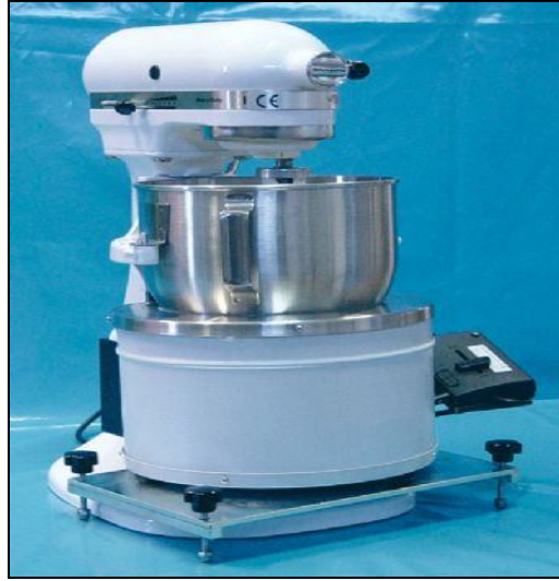
Şekil 3.2. Asfalt numunesi karıřtırma mikseri[51].
