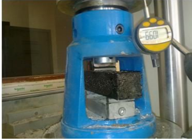
Şekil 2.7. Eğilme deneyinde sehim ölçümü
