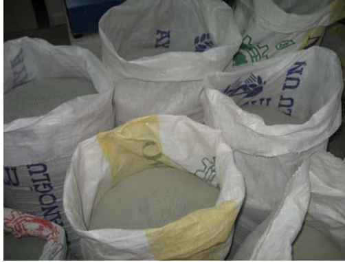
Şekil 2.1. Çeşitli boyutlarda elenerek depolanan agregalar
