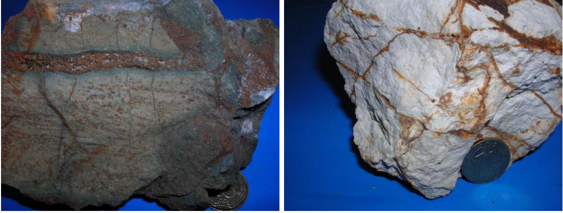
Şekil 3.34. a) Dasitteki hematit bantlarının ve beneklerinin görünümü (Örn. No: HS-5P) ve b) Dasitik tüfdeki hematit-limonit damarcıklarının görünümü (Örn. No: HS-10P)
