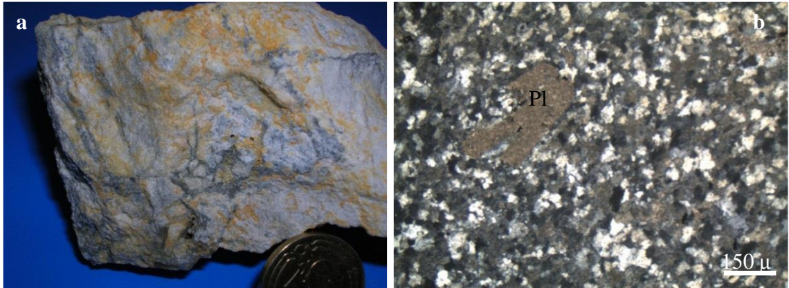
Şekil 3.29. a) Ayrılmış dasitik tufün makroskobik görünümü. b) Tamamen karbonatlaşmış plajiyoklasın ince kesitteki görünümü. (Örn. No: HS-27P) Pl: Plajiyoklas
