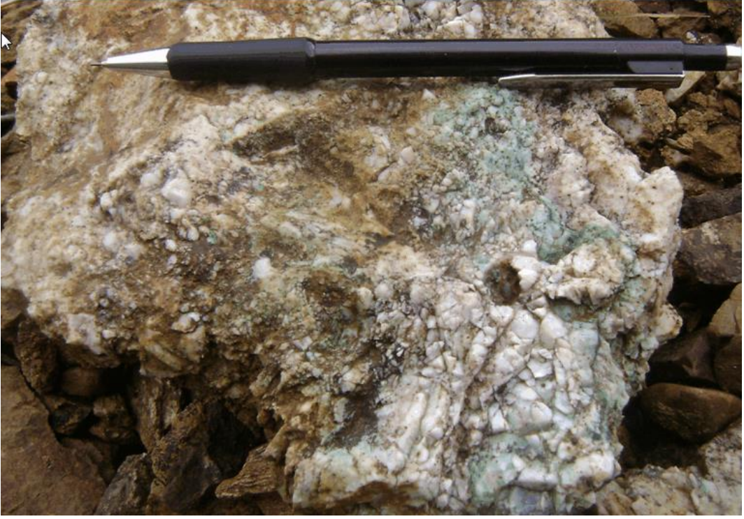
Şekil 3.32.Manganez cevherleşmesinin görüldüğü yerde malakit ve azurit minerallerinin görünümü (Turkuaz ve yeşil renkli kısımlar malakit, koyu mavi kısımlar azurit)
