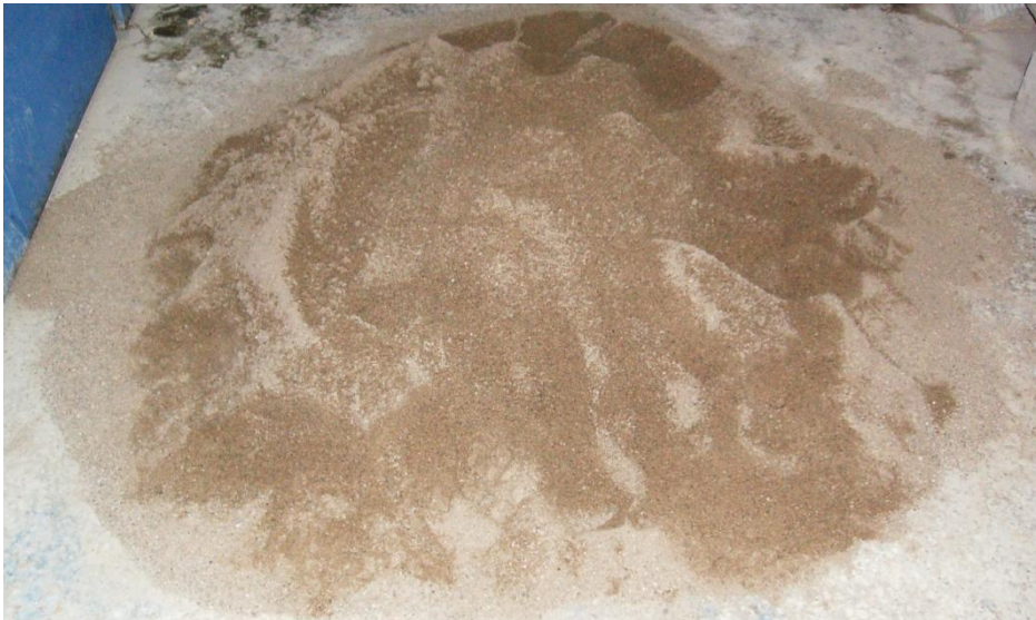
Şekil 1.9. Beton bileşiminde kullanılan agrega karışımı
