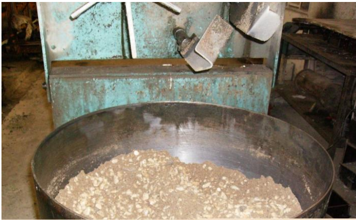
Şekil 1.6. Deneme karışımı yapılan karıştırıcının içine agreganın yerleştirilmesi
