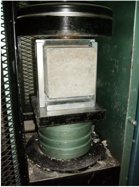
Şekil 1.1. Yarmada çekme deneyinin basınç düzeneğinde gerçekleştirilmesi
