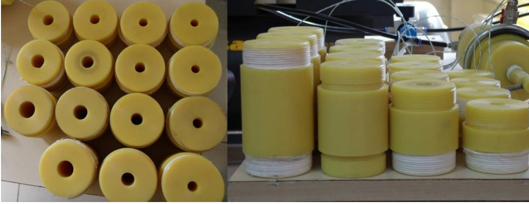
Şekil 2.4 Deneylerde kullanılan vorteks tüp gövdeleri
