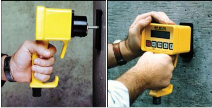
Şekil 1.11. Windsor probe penetrasyon test yöntemi aleti (NDT J. I., 2013).
