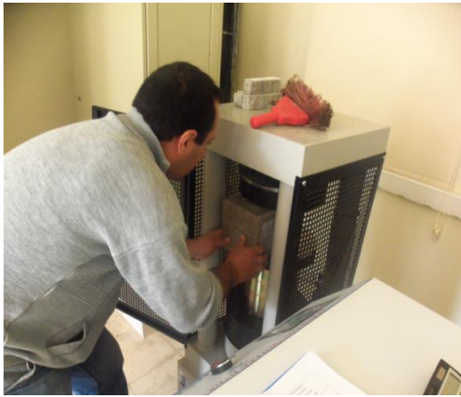
Őekil 2.6. Küp numunelerin beton basınç cihazına yerleřtirilmesi ve kırılması
