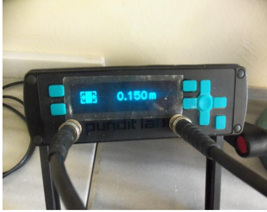
Şekil 2.2. Ultrases cihazı mesafe (m) ekranı
