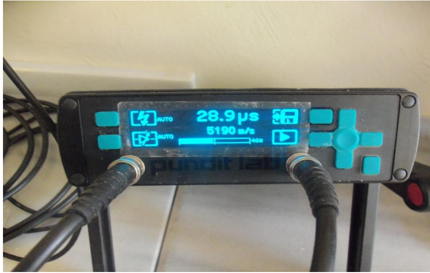
Şekil 2.4. Ultrases dalga hızı sonuç ekranı
