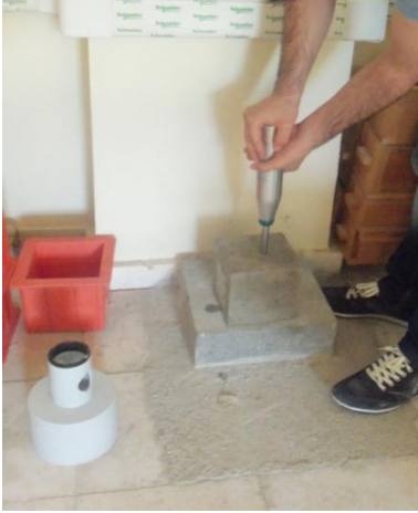
Őekil 2.5. Schmidt çekici ile yüzey sertliđinin okunması
