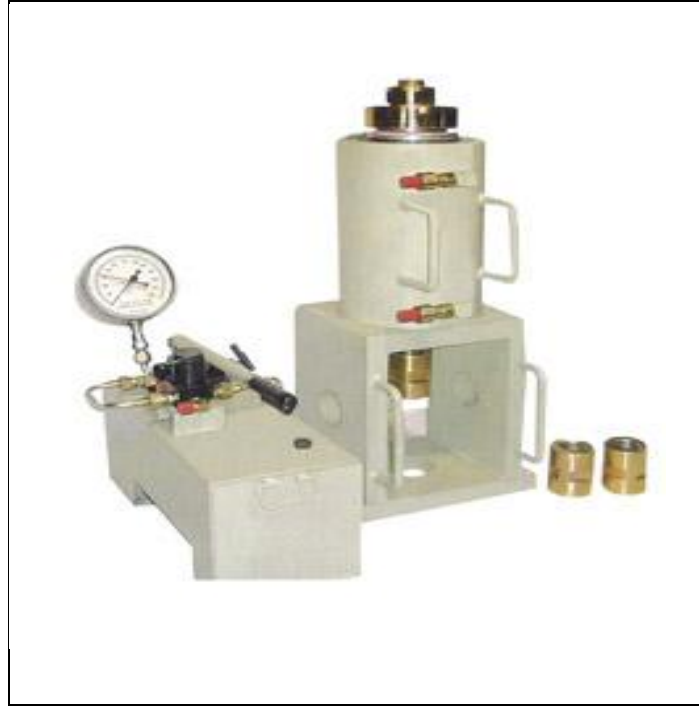
Şekil 1.13. Pull-out test yöntemi aleti (Zeal I., 2013).
