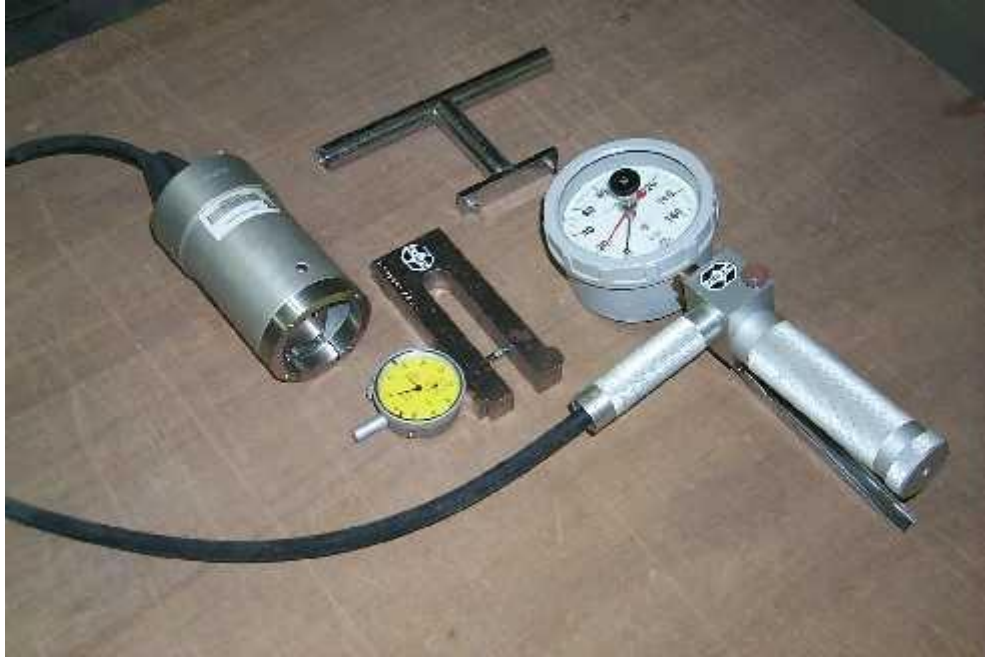
Şekil 1.14. Break-off test yöntemi aleti (NTU E., 2013).
