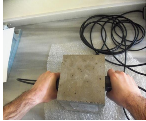
Şekil 2.3. Karşılıklı okuma yapılması
