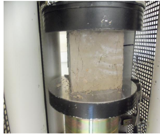
Őekil 2.6. Küp numunelerin beton basınç cihazına yerleřtirilmesi ve kırılması
