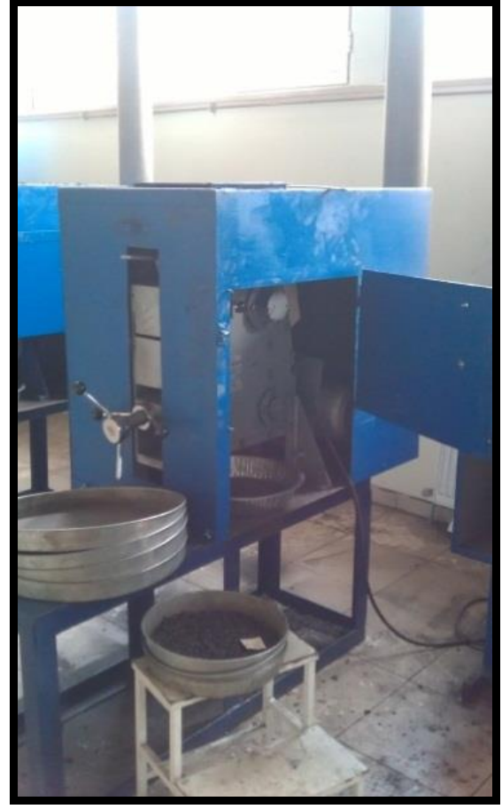
Şekil 2.2. Numunelerin analize hazır hale getirilmesinde kullanılan çeneli kırıcı
