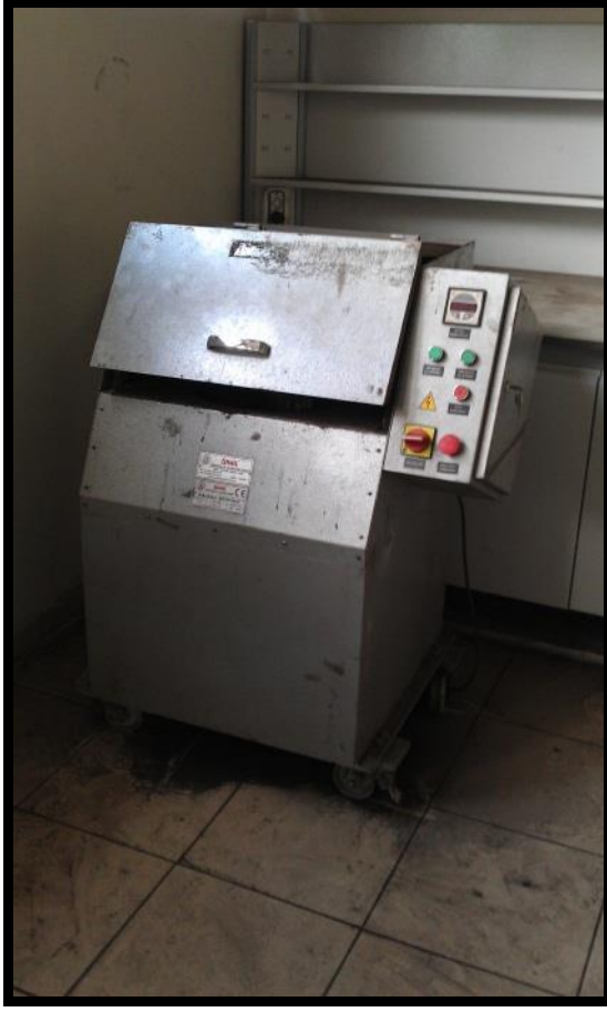
Şekil 2.1. Numunelerin analize hazır hale getirilmesinde kullanılan diskli kırıcı
