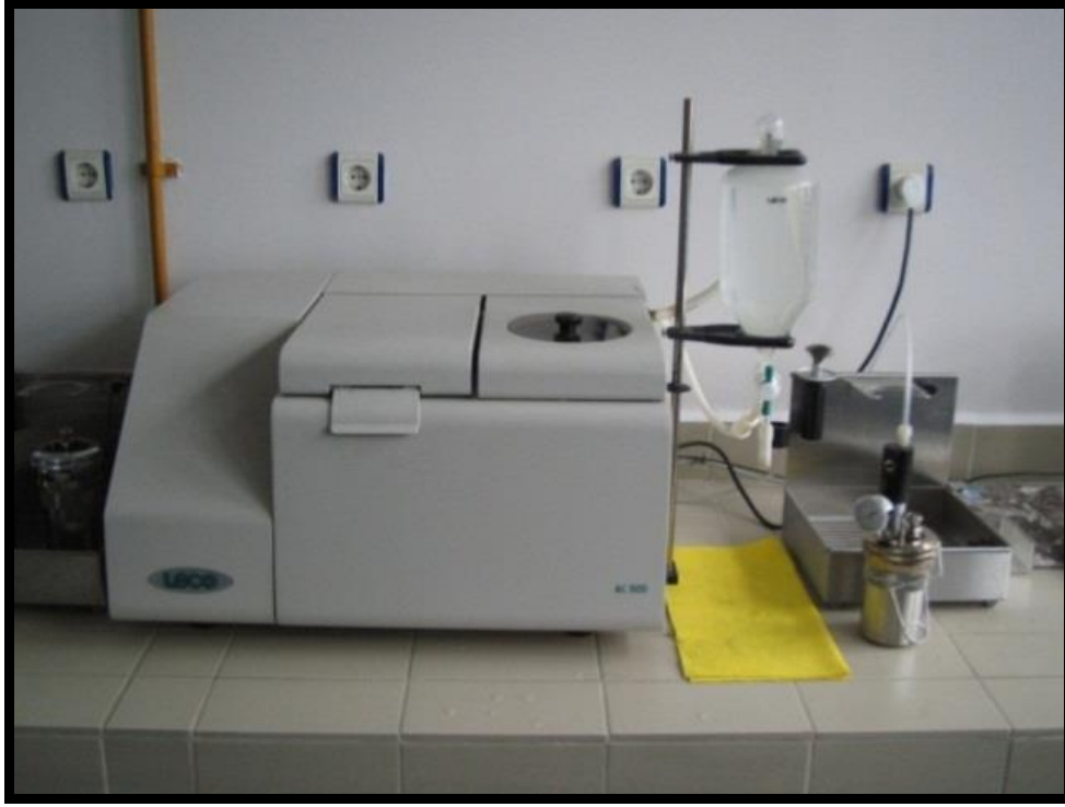
Şekil 2.4. Kömür numunesinin ısı değeri analizini yapan kalorimetre analiz cihazı - Leco AC 500
