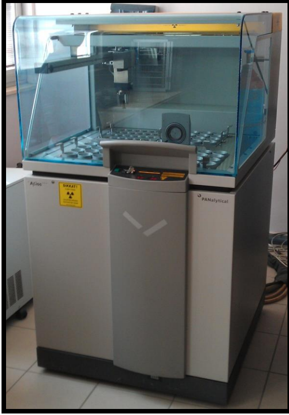
Şekil 2.13. Panalytical Axios XRF Cihazı
