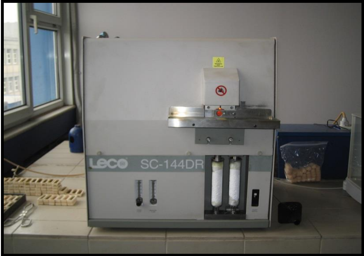
Şekil 2.6. Kömür numunesinde toplam kükürt ve külde kükürt analizini yapan kükürt analiz cihazı - Leco SC 144 DR.
