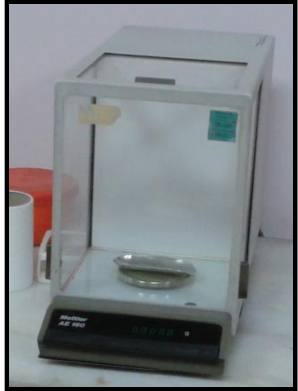
Şekil 2.8. Tartım için kullanılan hassas terazi
