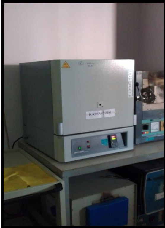
Şekil 2.7. Külleştirmek için kullanılan fırın
