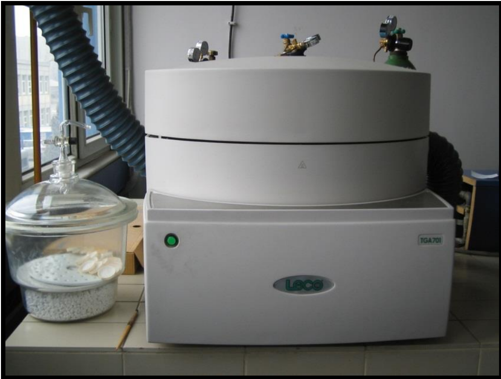
Şekil 2.5. Kömür numunesinde nem, uçucu madde ve kül analizlerini yapan termogravimetrik analiz cihazı - TGA 701
