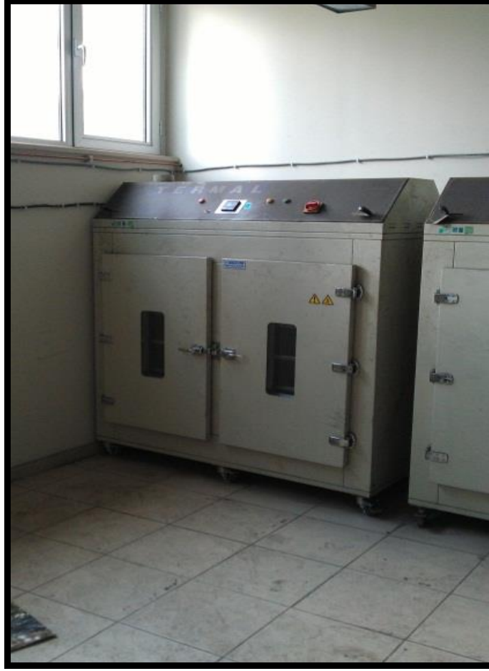
Şekil 2.3. Numunelerin kurutulduğu etüv cihazı
