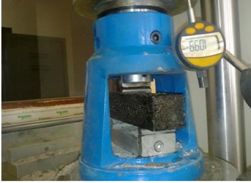
Şekil 2.6 Eğilme deneyinde sehim ölçümü
