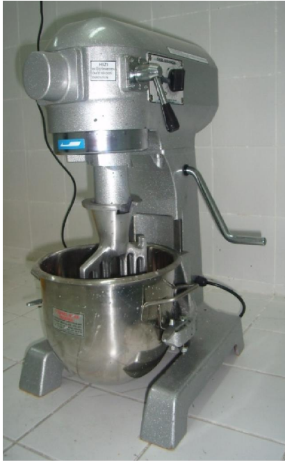
Şekil 2.3. Özel tasarım çimento harç karıştırıcısı
