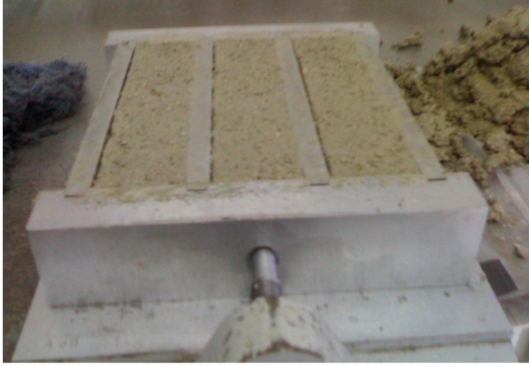
Şekil 2.4 Sıkıştırıldıktan sonra yüzeyi düzeltilmiş harç örneği
