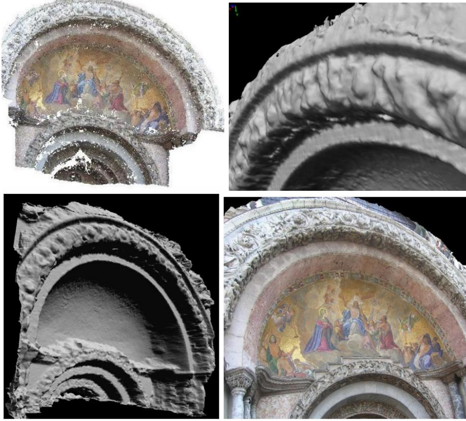
Şekil 2.11. Görüntü ve mesafe bazlı ölçme sistemlerini kıyaslanması (Remondino ve Zhang, 2006).
