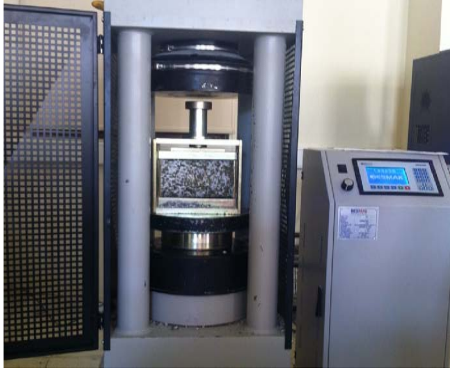
Şekil 2.7. Yarmada çekme dayanımı aparatı
