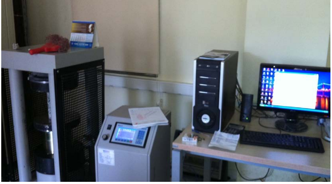
Şekil 2.6. Labaratuvardaki bilgisayar kontrollü basınç presi
