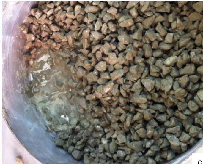
Şekil 2.1. Deneme karışımları: a-normal, b-az akıcı, c-çok akıcı
