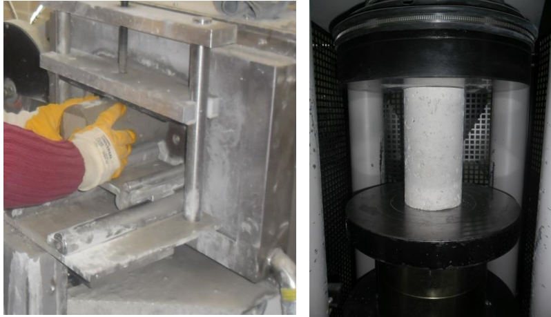
Şekil 2.6. Beton yüzeylerinin başlıklanması ve kırılması
