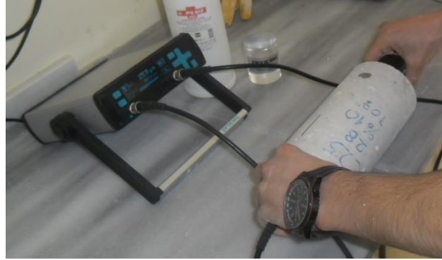
Şekil 2.9. Beton test çekici ve Ultrasonik ses geçiş hızı ölçümlerinin yapılması
