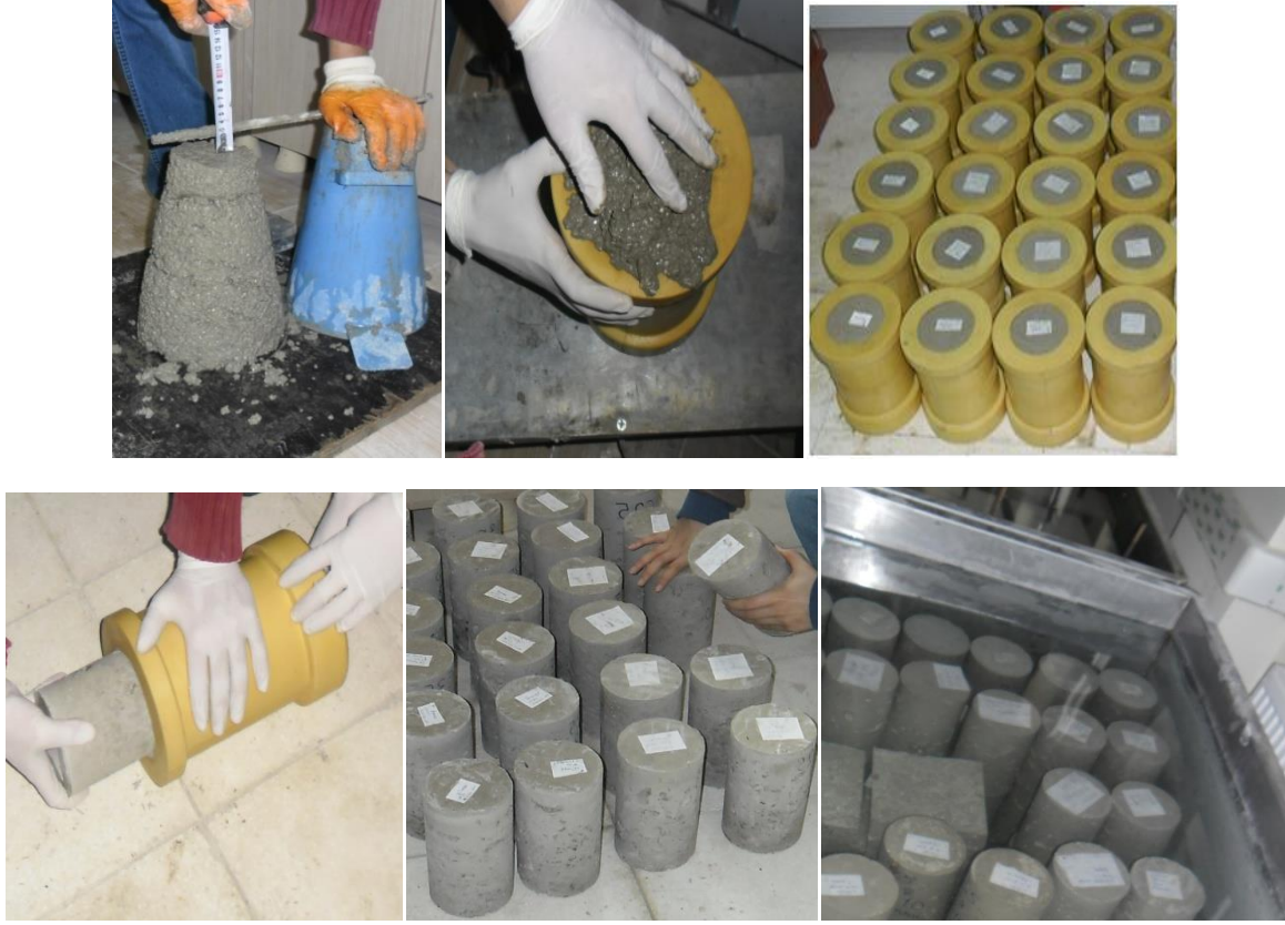
Şekil 2.4. Taze beton Çökme deneyi ve kür havuzuna yerleştirilmesi
