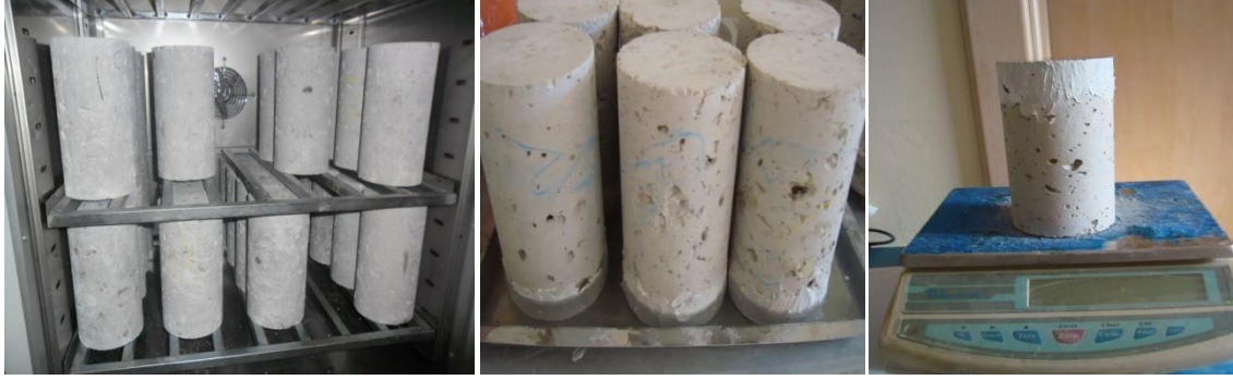
Şekil 2.10. Kapiler su emme deneyinin yapılması
