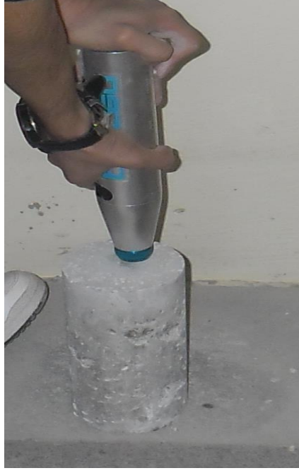
Şekil 2.8. Beton test çekicinin beton numuneye uygulanışı
