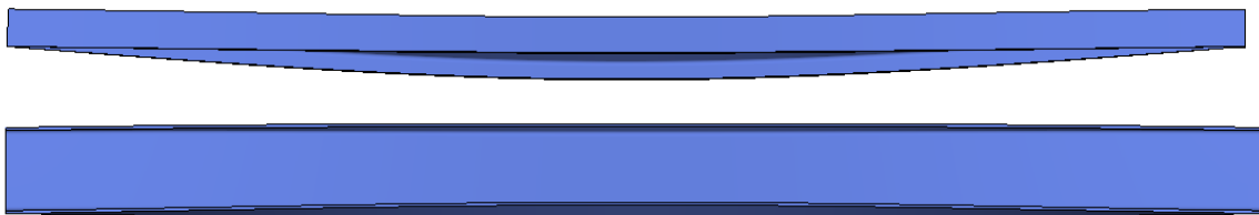
Şekil 3.9. 6 m uzunluğundaki basit kirişin yanal burkulmuş hali (üstten ve önden)
