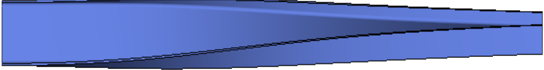
Şekil 3.20. 6 m uzunluğundaki konsol kirişin \beta_y = 250\text{ kN/m} için yanal burkulmuş hali
