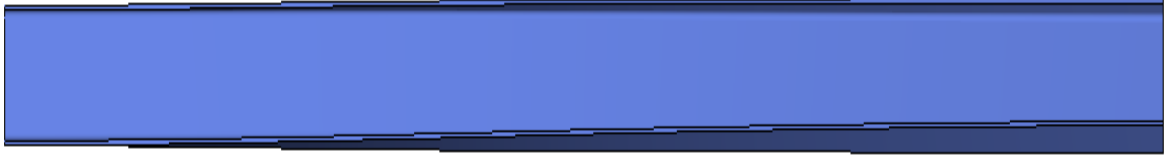
Şekil 3.19. 6 m uzunluğundaki konsol kirişin \beta_y = 50\text{kN/m} yanal burkulmuş hali
