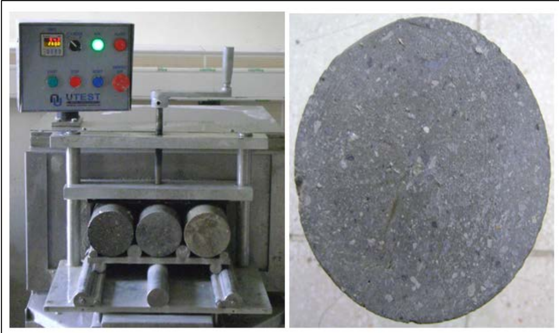
Şekil 3.12. Numune başlıklama cihazı ve yüzeyi düzeltilmiş örnek
