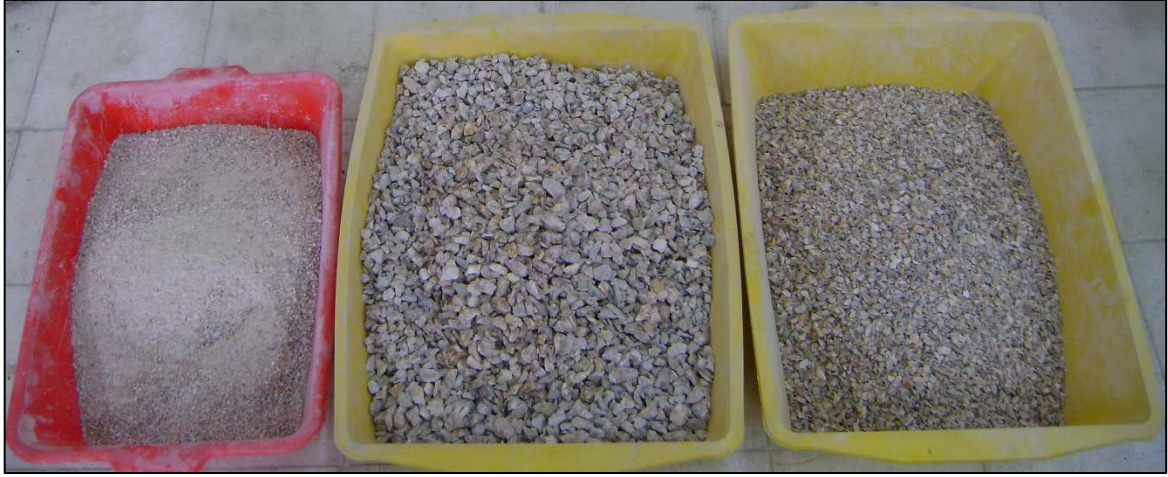
Şekil 3.3. Çeneli kırıcıda kırılmış sınıflarına ayrılmış barit agregası
