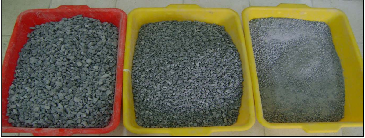
Şekil 3.6. Çeneli kırıcıda kırılmış sınıflarına ayrılmış pasa agregası
