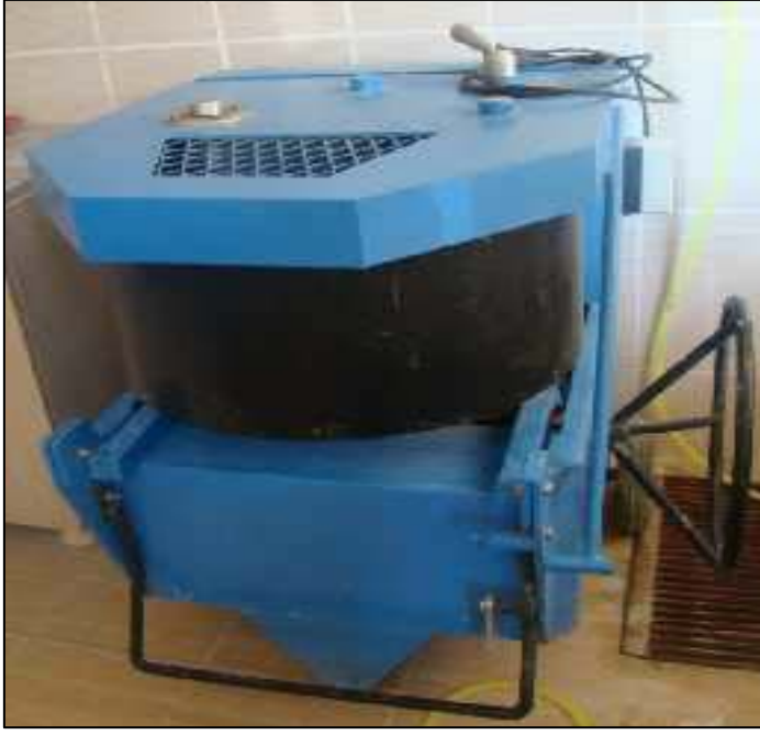
Şekil 3.9. Düşey Eksenli Cebri Karıştırmalı Mikser
