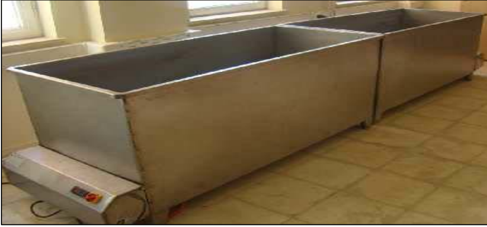
Şekil 3.11. Isı kontrollü kür havuzları
