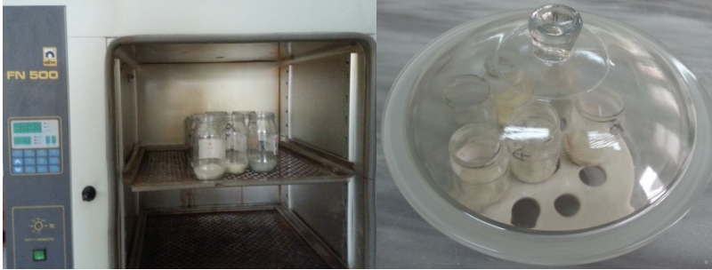
Şekil 2.2. Etüvden çıkarılan numunelerin desikatörde soğutulması
