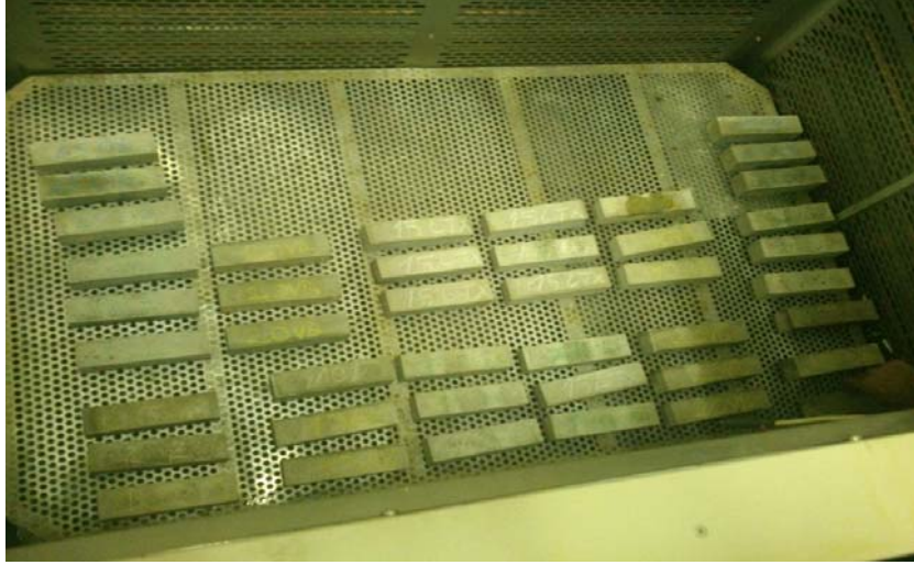
Şekil 2.8. Numunelerin donma-çözülme aletine yerleştirilmesi
