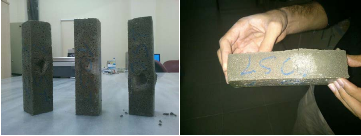
Şekil 3.20. 200 döngü sonunda %10 SAC katkıli numuneler
