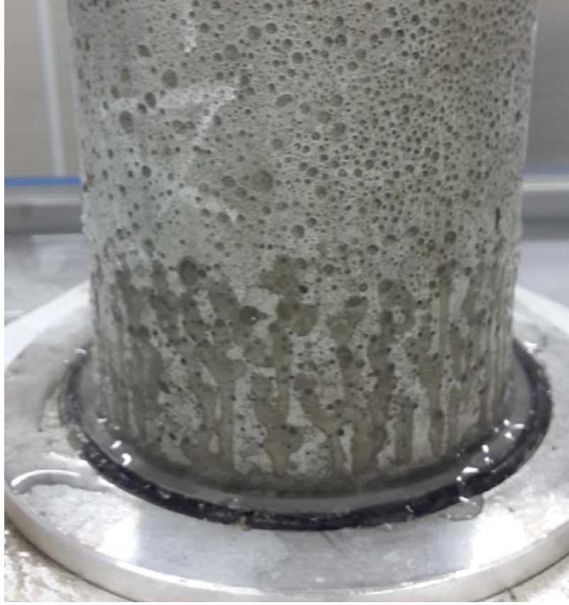
Şekil 3.5. SAC katkılı numunenin su işleme derinliği deneyi sırasındaki davranışı
