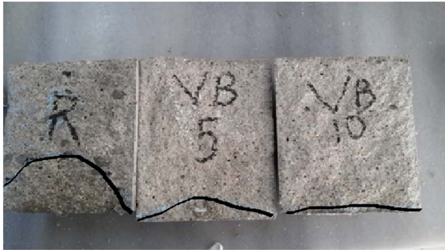
Şekil 2.11. Su işleme derinliğinin belirlenmesi
