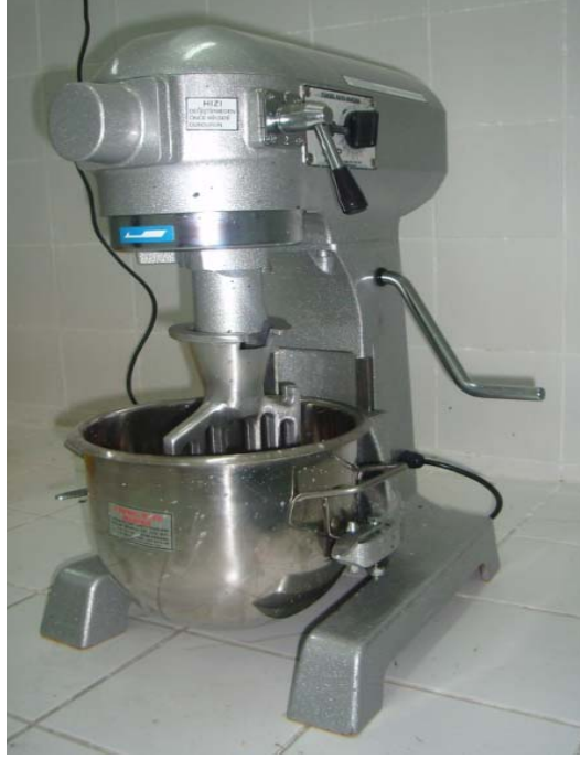
Şekil 2.3. Özel tasarım çimento harç karıştırıcısı
