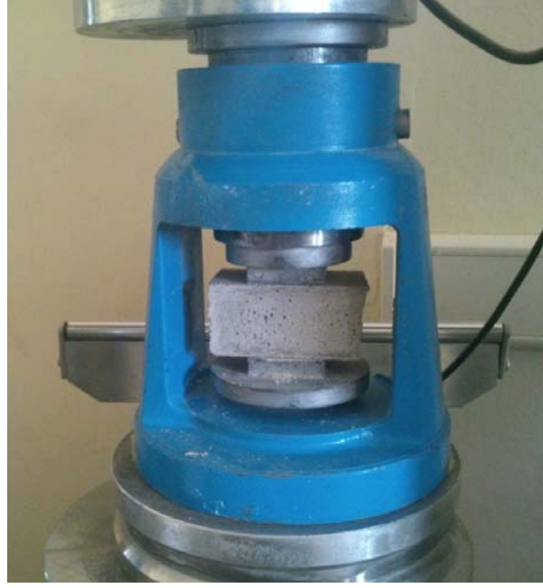
Şekil 2.7. Basınç dayanımının ölçülmesi
