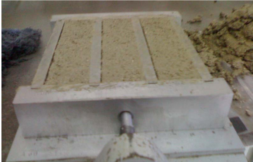
Şekil 2.4. Sıkıştırıldıktan sonra yüzeyi düzeltilmiş harç örneği
