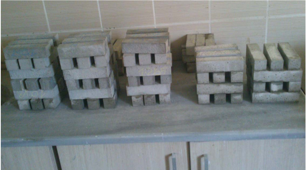
Şekil 2.5. Numunelerin 1. Koşulda kür edilmesi
