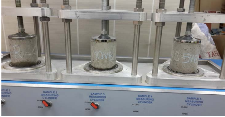
Şekil 2.10. Su işleme derinliği deneyi
