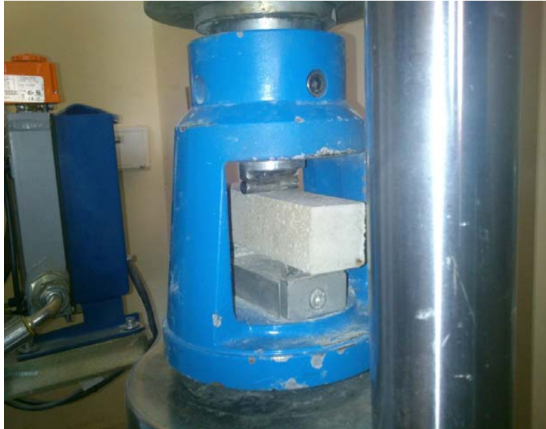
Şekil 2.6. Eğilme dayanımının ölçülmesi
