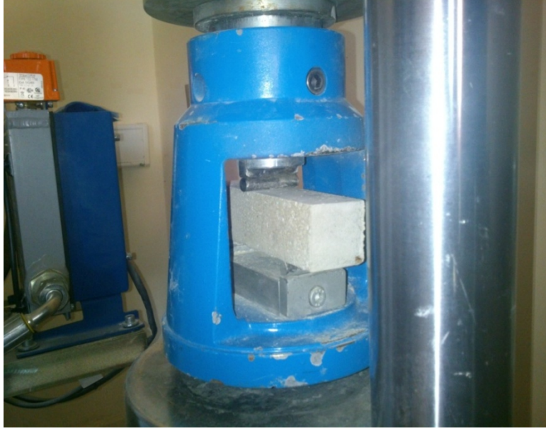
Şekil 2.5. Eğilme dayanımının ölçülmesi
