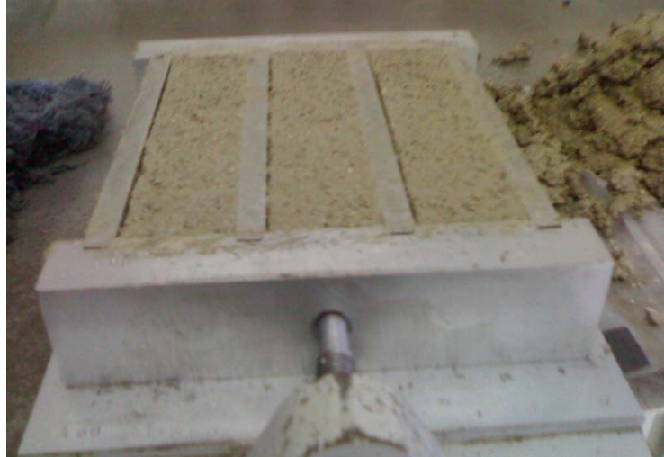
Şekil 2.4. Sıkıştırıldıktan sonra yüzeyi düzeltilmiş harç örneği
