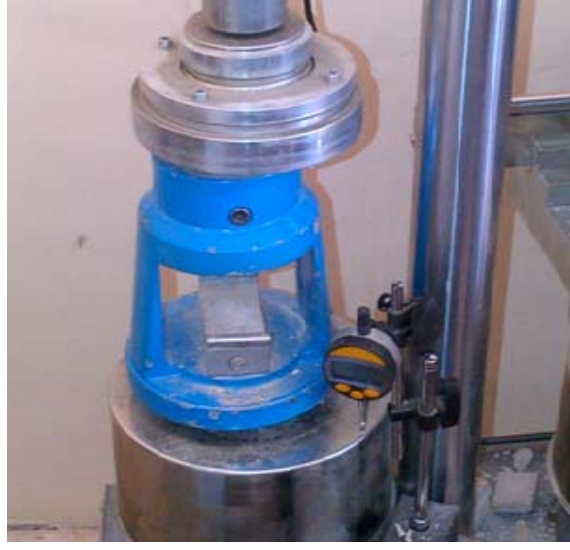
Şekil 2.6. Eğilme deneyinde sehim ölçümü
