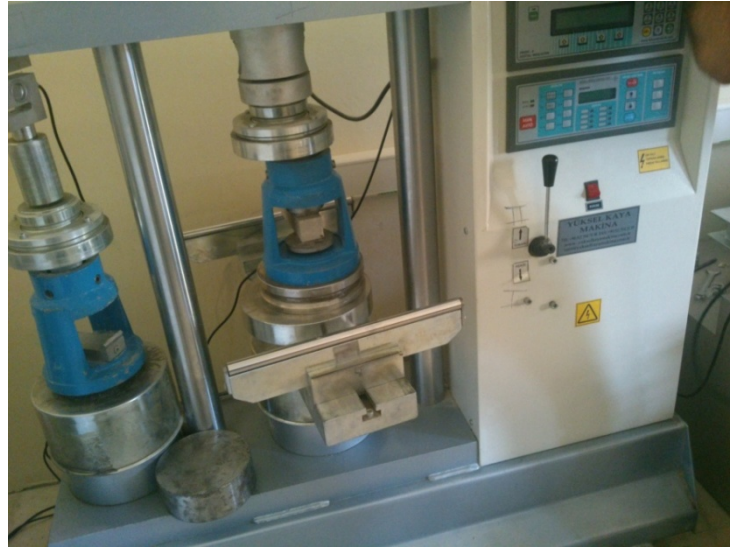
Şekil 2.7. Basınç dayanımının ölçülmesi
