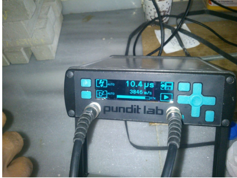
2.10.Ultrasonik test cihazı
