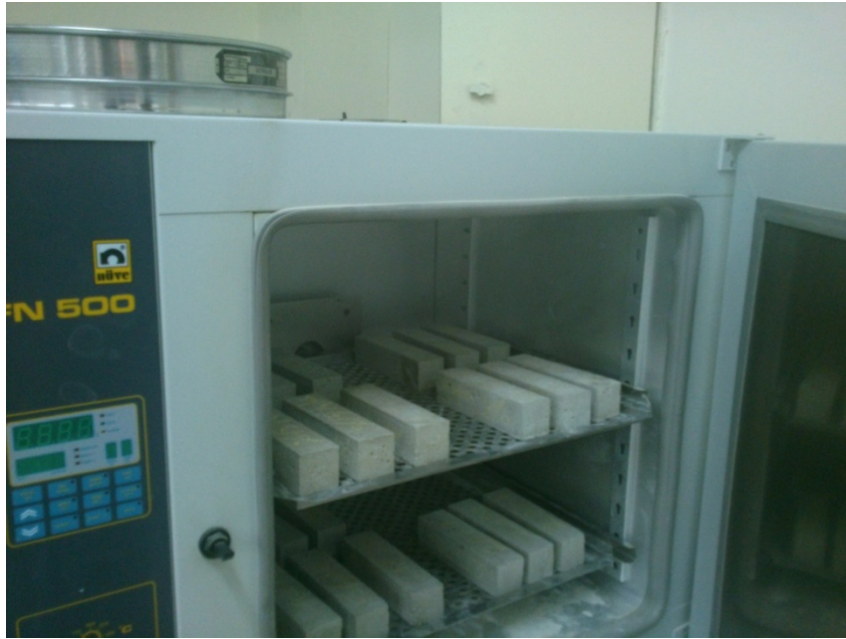
Şekil 2.8. Numunelerin etüve yerleştirilmesi
