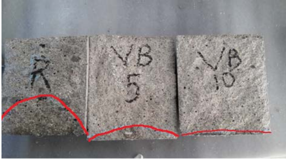
Şekil 2.12. Su işleme derinliğinin belirlenmesi
