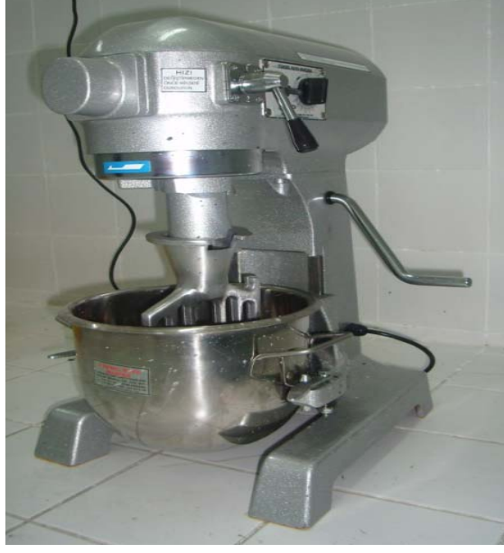
Şekil 2.3. Özel tasarım çimento harç karıştırıcısı
