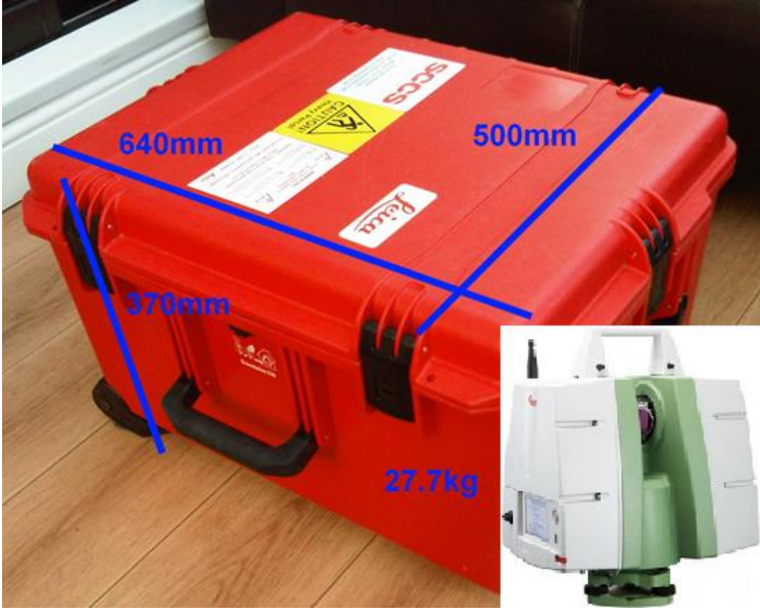
Şekil 4.1. Uygulamada kullanılan Leica c10 lazer tarayıcı ve taşıma çantasının boyutları (URL-2).
