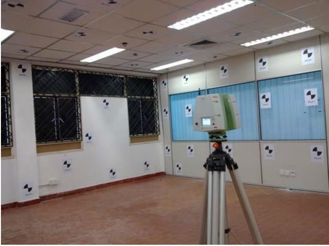
Şekil 2.12. Leica c10 otomatik kalibrasyon alanı (Abbas Vd, 2013)
