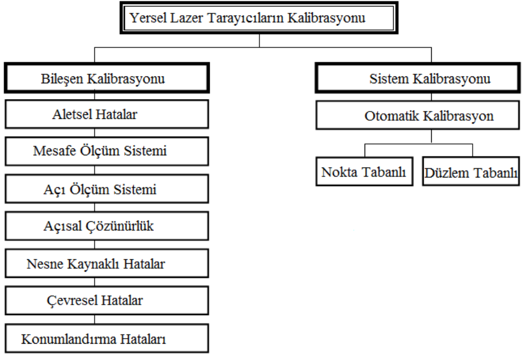
Şekil 2.10 Yersel lazer tarayıcıların kalibrasyon işlemi (Abbas Vd, 2013)
