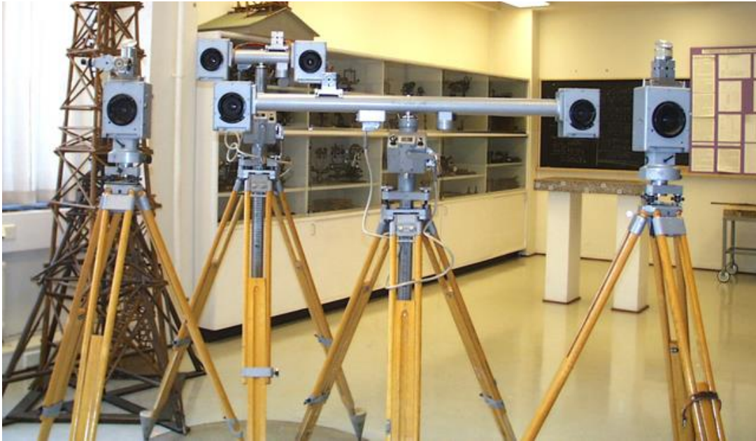
Şekil 3.4. Alet sehvası üzerine monte edilmiş metrik ve stereometrik kameralar
