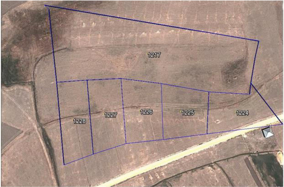
Şekil 2.1. Plandaki sınır ile zemindeki sınırın çakıştırılması
