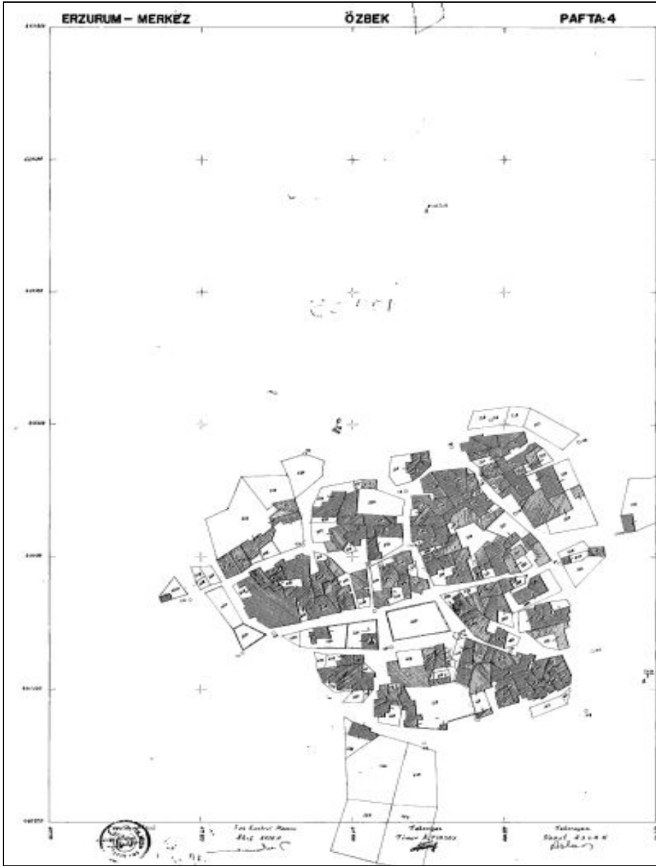
Şekil 1.7. Prizmatik yöntemle üretilen pafta
