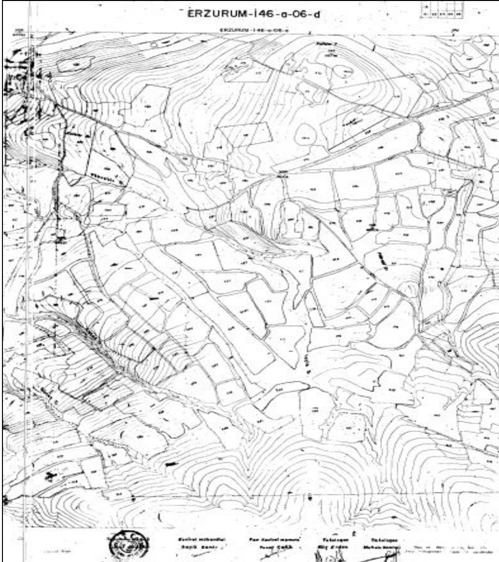
Şekil 1.8. Fotogrametrik yöntemle üretilmiş kadaastro haritası
