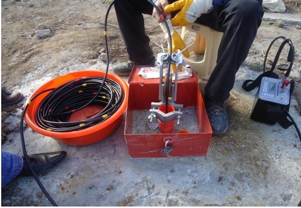
Şekil 1.29. İnklinometre deney sisteminin kısımları
