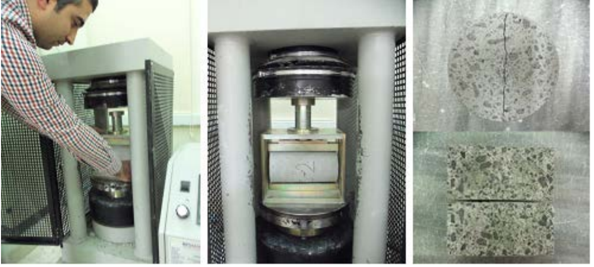
Şekil 3.17. Yarmada Çekme dayanımı deneyinin yapılışı ve numunesi
