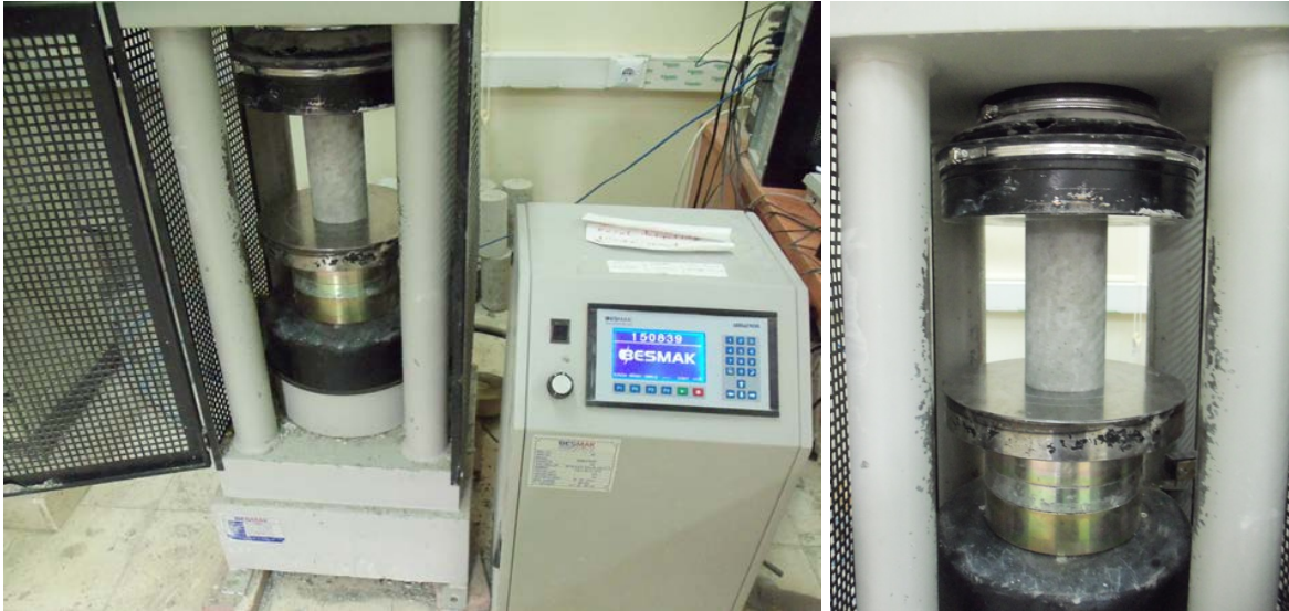
Şekil 3.14. Tek eksenli tahribatlı yöntemle basınç dayanımının belirlenmesi
