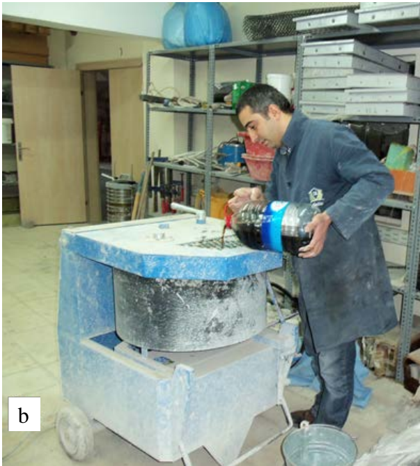
řekil 3.7. Beton 6rneklerinin 6retimi; a) Malzemelerin kuru karıřtırılması, b) Karıřıma akıřkanlařtırıcı katkılı su ilavesi
