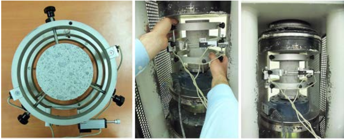
Şekil 3.16. Beton numunelerin elastisite modülü deneyinin yapılışı
