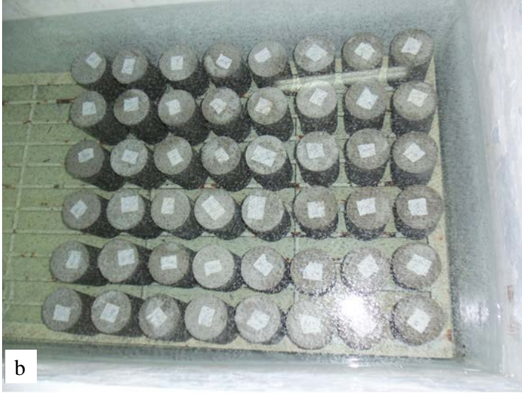
Şekil 3.10. Betonların kür havuzuna yerleştirilmesi ve bekletilmesi; a) Betonların kür havuzuna yerleştirilmesi, b) Kür havuzunda bekletilmesi
