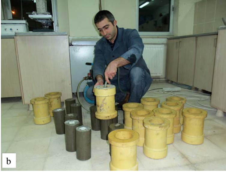
Şekil 3.9. Betonların kür edilmesi ve kalıplardan çıkarılması; a) Betonların 1 gün kalıpta bekletilmesi, b) Betonların kalıplardan çıkarılması
