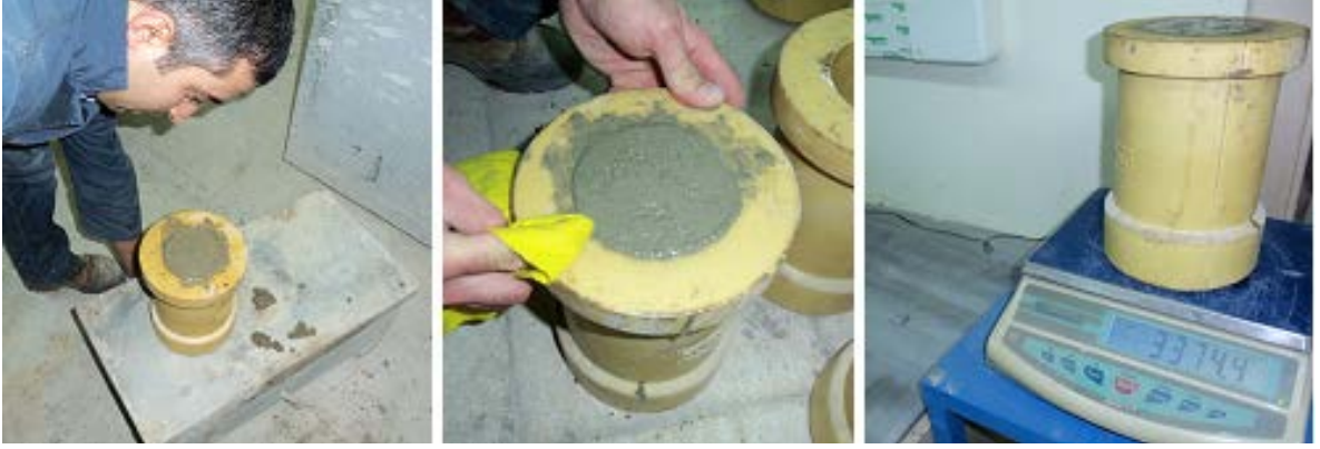
Şekil 3.12. Taze beton birim kütleinin belirlenmesi
