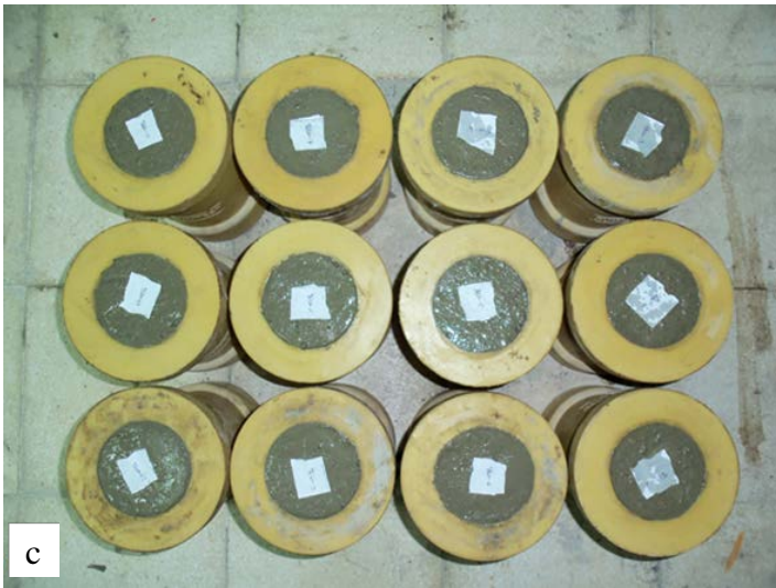
Şekil 3.8. Betonların kalıplara yerleştirilmesi; a) Betonun kalıba yerleştirilmesi, b) Kalıntıların temizlenmesi, c) Beton cinsinin adlandırılması
