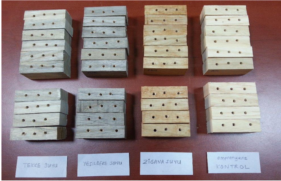
Őekil 3.13. Larva deneyi için hazırlanmıř emprenyeli adi diřbudak odun örnekleri
