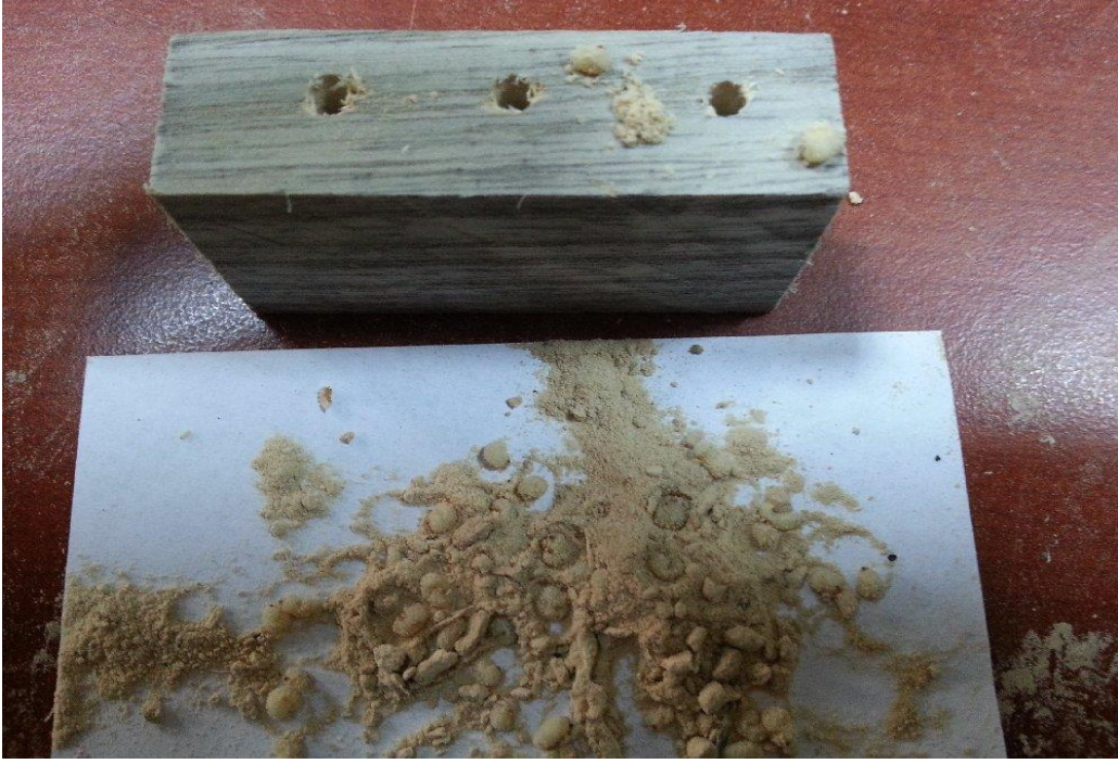
Şekil 3.14. Adi dişbudak odun örneklerinde açılan deliklere larvaların yerleştirilmesi
