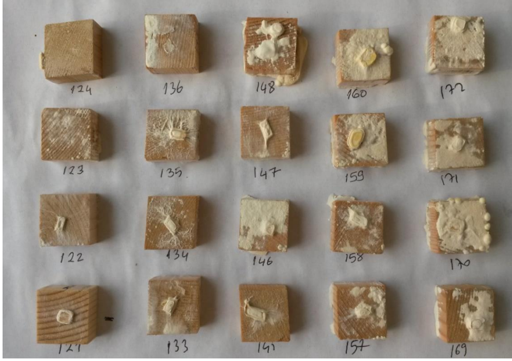
Şekil 3.2. Beyaz çürüklük ( Cv-Coriolus versicolor ) mantarının penetrasyonu-1
