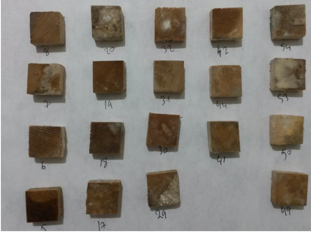
Şekil 3.8. Esmer ürüklük ( Gt-Gloeophyllum trabeum ) mantarının odun örneklerinde penetrasyonu-3
