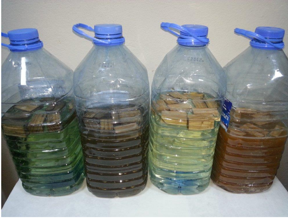
Şekil 3.12. Böcek deneyi için mineral sular içerisinde emprenye edilmekte olan adi dişbudak odun örnekleri
