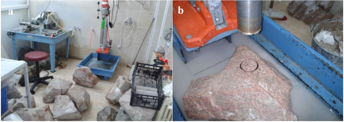
Şekil 2.1. Blokların örnekler (a) ve karot kesim işleme (b)
