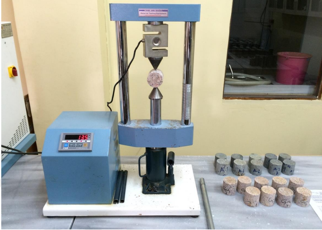
Şekil 2.11. Nokta yük deney aleti ve silindirik karot örnekler
