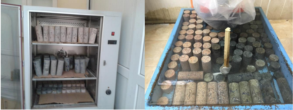
Şekil 2.3. Etüv ve kür havuzundan bir görünüm
