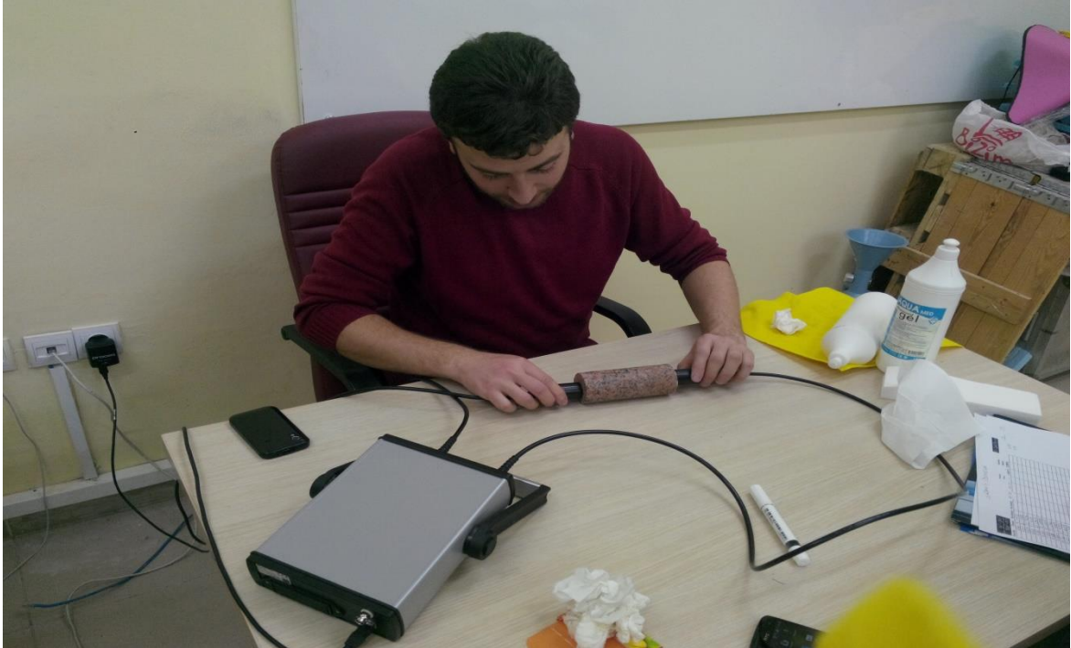
Şekil 2.4. Boyuna dalga hızı ( V_p ) ölçümü
