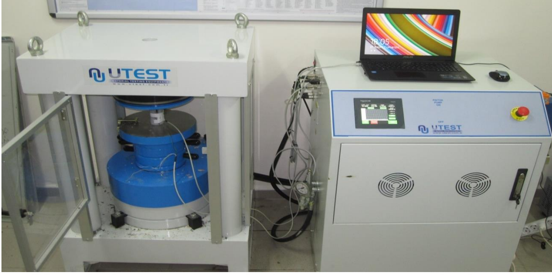
Şekil 2.8. Deformasyon ölçerli tek eksenli sıkışma dayanım cihazı
