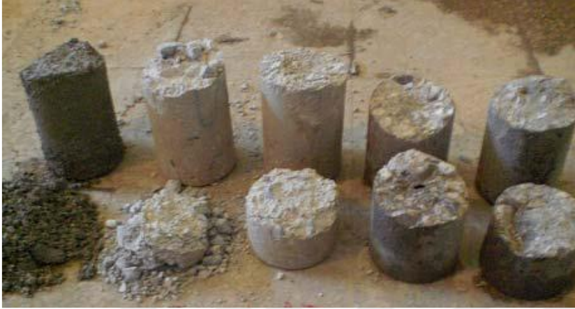
Şekil 2.5. Donma-çözülme sonunda 0°C derecede üretilen referans beton örneklerdeki deformasyon (Çullu, 2009)
