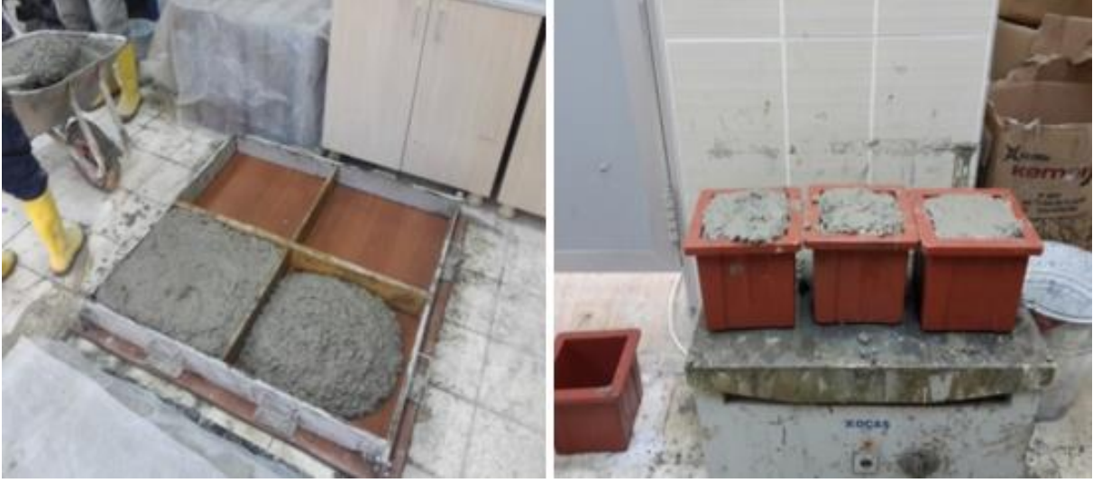
Şekil 3.1. Normal beton üretiminde kullanılan kalıplar
