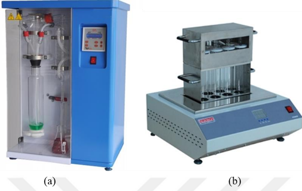
Şekil 2.4. (a) Protein tayin cihazı, (b) Protein yakma ünitesi
