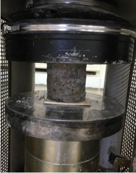
Şekil 2.6. Beton basınç deneyi
