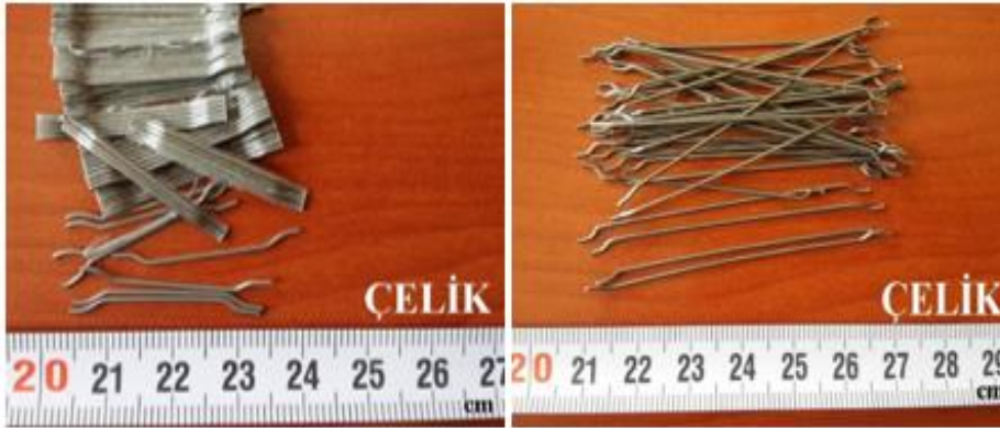
Şekil 2.3. Betonda kullanılan kısa ve uzun çelik lifler
