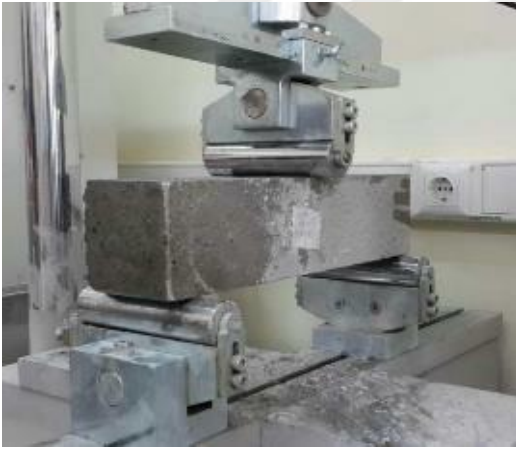
Şekil 2.7. Eğilme basınç deneyi
