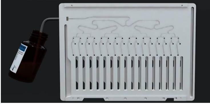
Şekil 1.1. TEMPO besiyeri şişesi ve numune kartı
