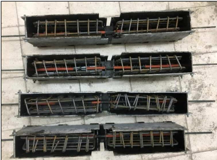
Şekil 2.2. Mafsallı kirişlerin üretiminde kullanılan modüler çelik kalıplar
