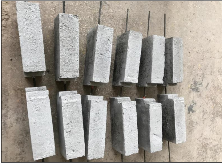
Şekil 2.6. Üretilen ve deneye hazır hale getirilen mafsallı kiriş örnekleri
