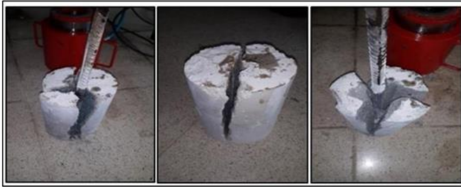
Şekil 1.15. Numunelerin çekip çıkarma deneyinde kırılma şekli
