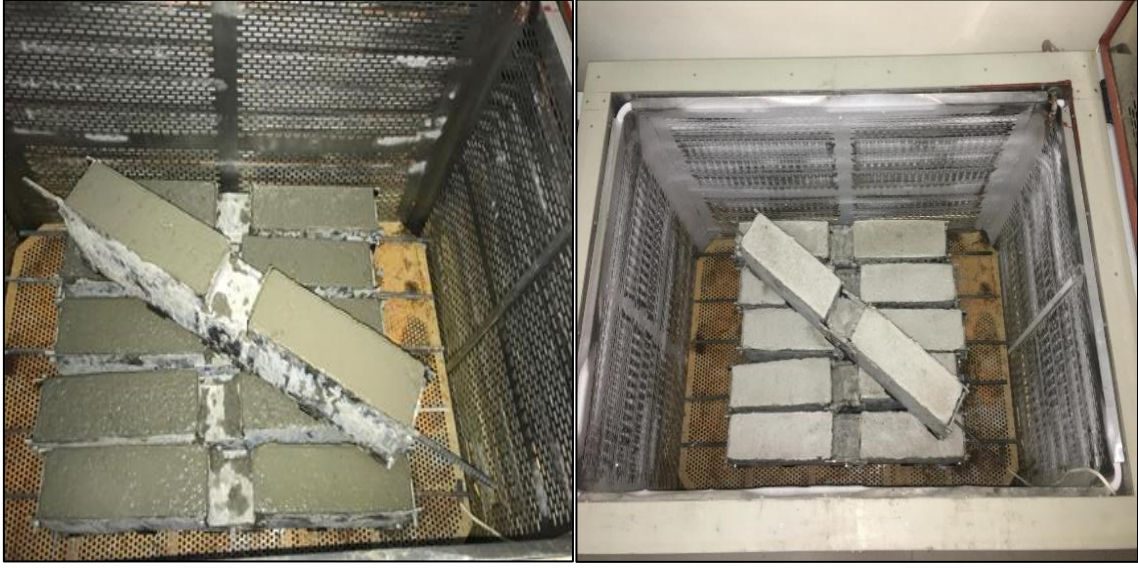
Şekil 2.5. Dondurucu dolap içerisindeki kiriş örnekler
