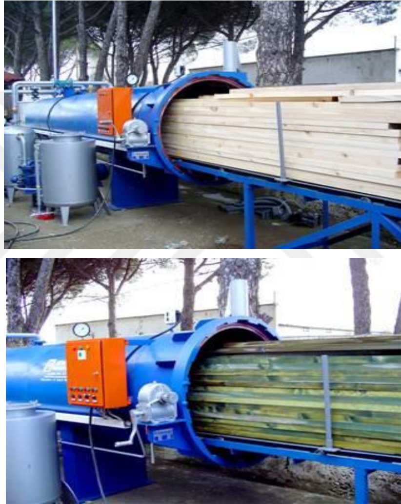
Şekil 1.1. Dolu hücre metoduna göre empenye yapan bir basınç kazanı (URL, 2007).
