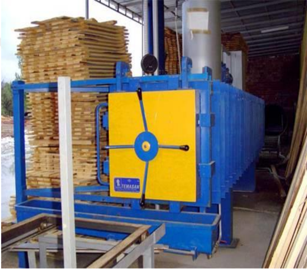
Şekil 1.2. Boş hücre metodu ile emprenye yapan basınç kazanı
