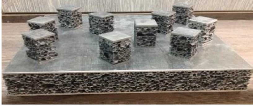
Şekil 2.7. Alüminyum köpük sandviç panel (Raeisi vd., 2019)
