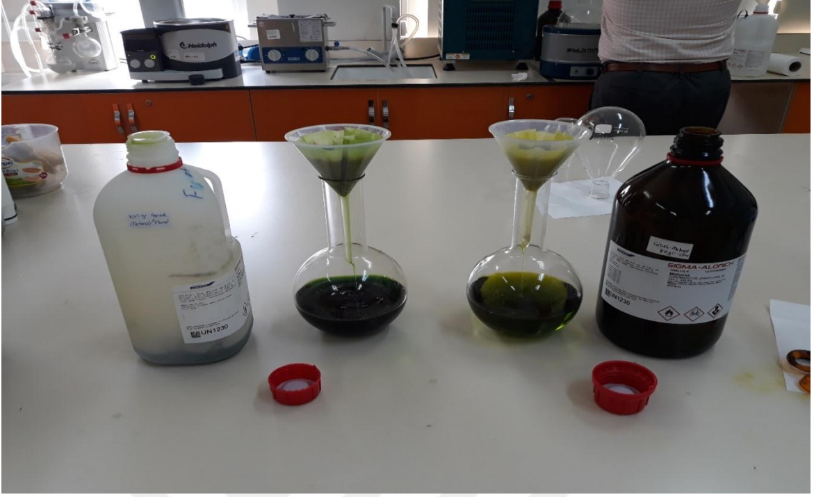
Şekil 2.6. Filtreden süzölen çiçek ve yaprak örnekleri
