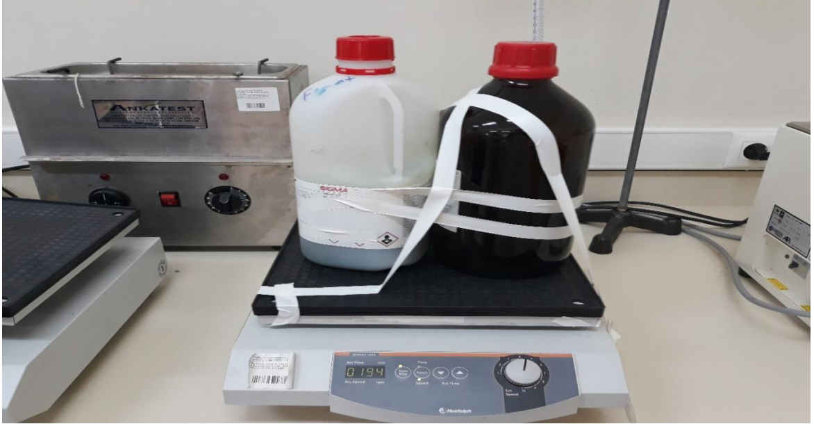
Şekil 2.5. Metanol eklenerek çalkalayıcıya konulan çiçek ve yaprak örnekleri
