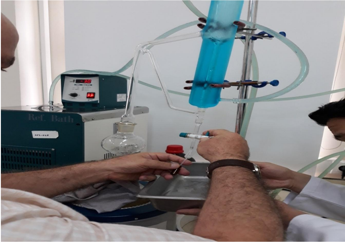
Şekil 2.4. Toplanan uçucu yağların renkli şişelere (vial) konulması
