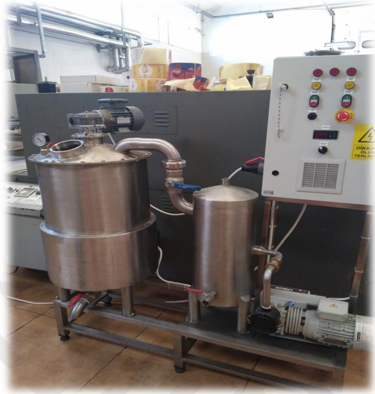
Şekil 2.5. Yağ ısıtılmalı kazan
